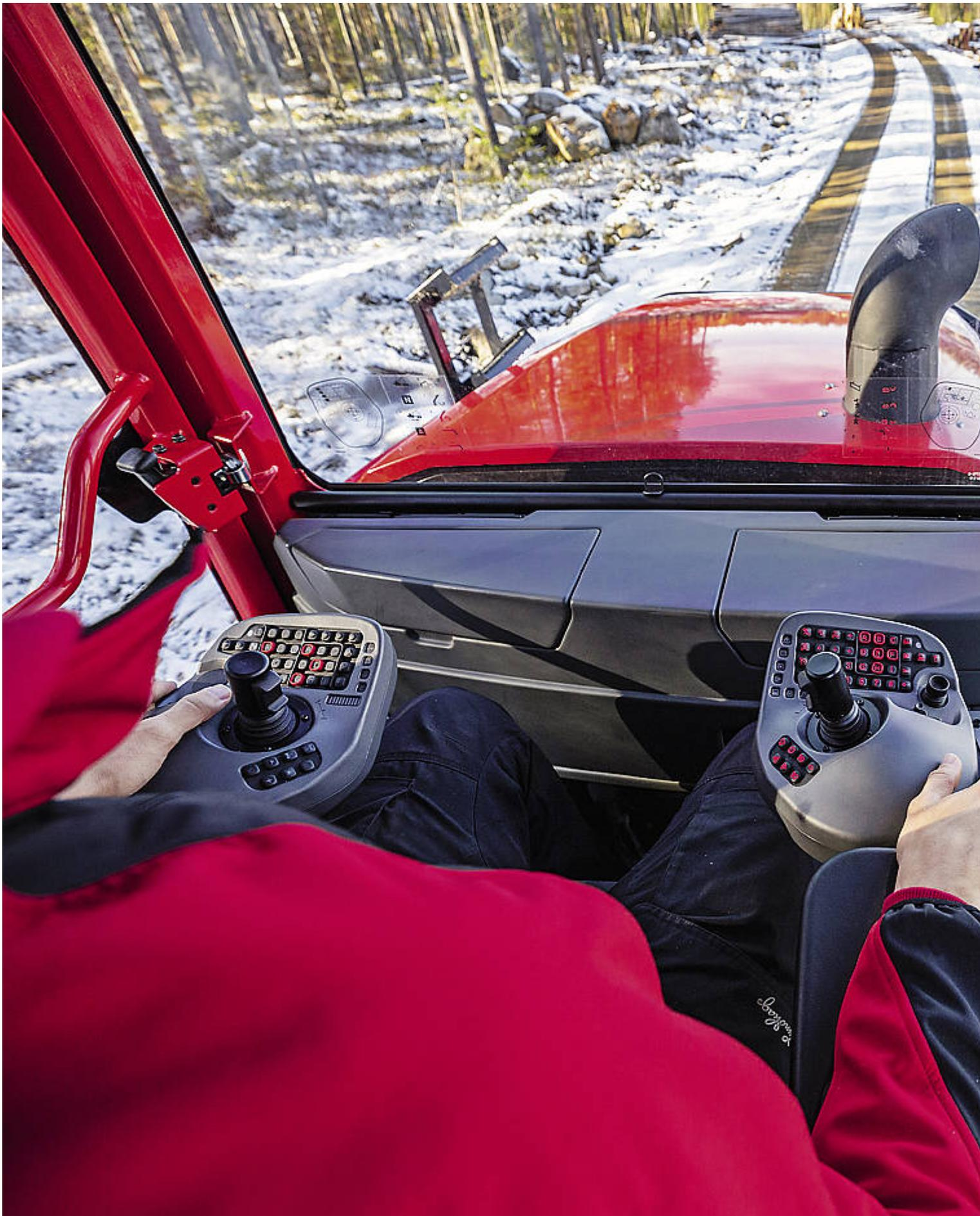
Das bisherige Orbitrol-Lenkrad wurde durch eine Mini-Lenkung an der rechten Armlehne ersetzt.
