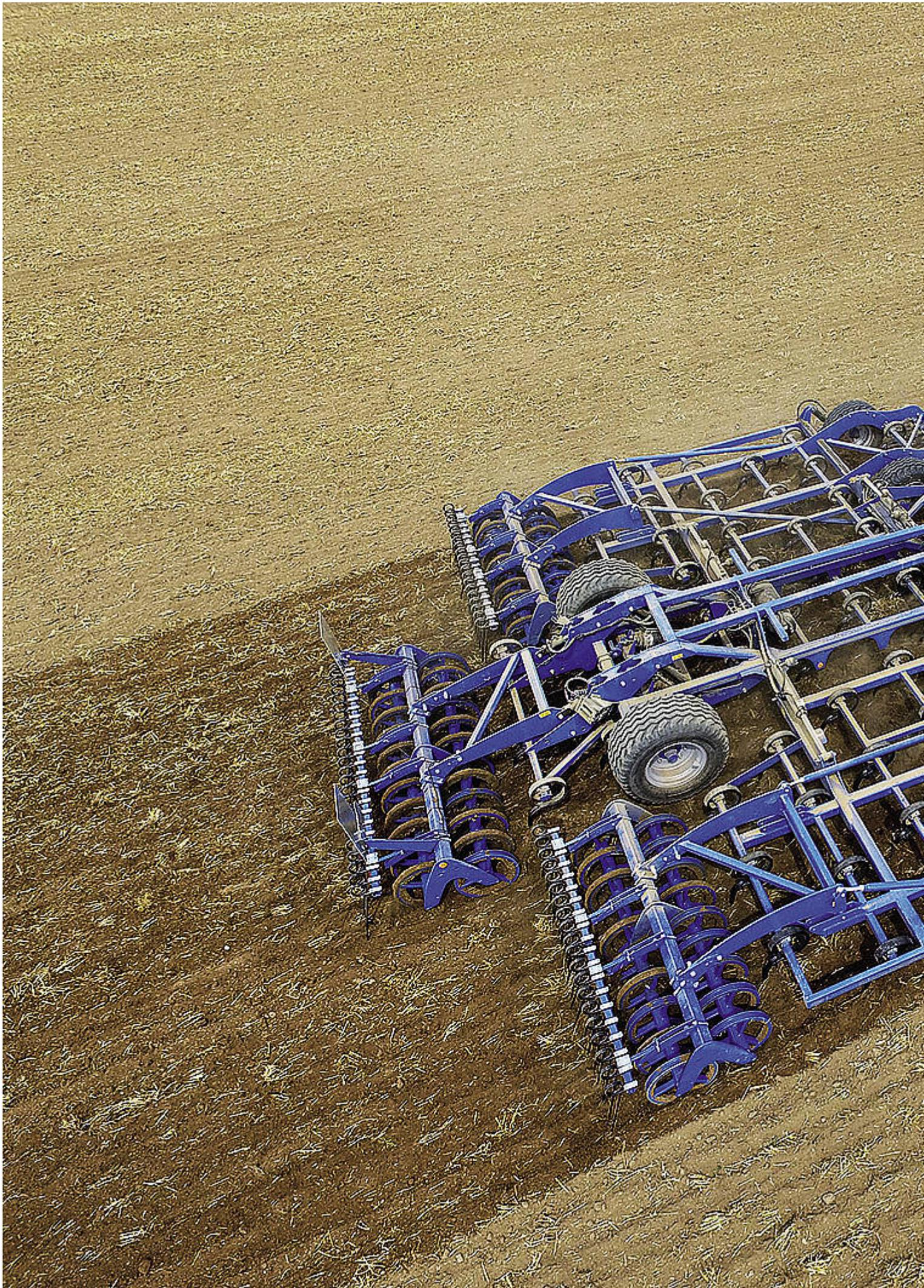
Durch die lange Bauform können große Mengen organischer Masse gut eingearbeitet werden.
