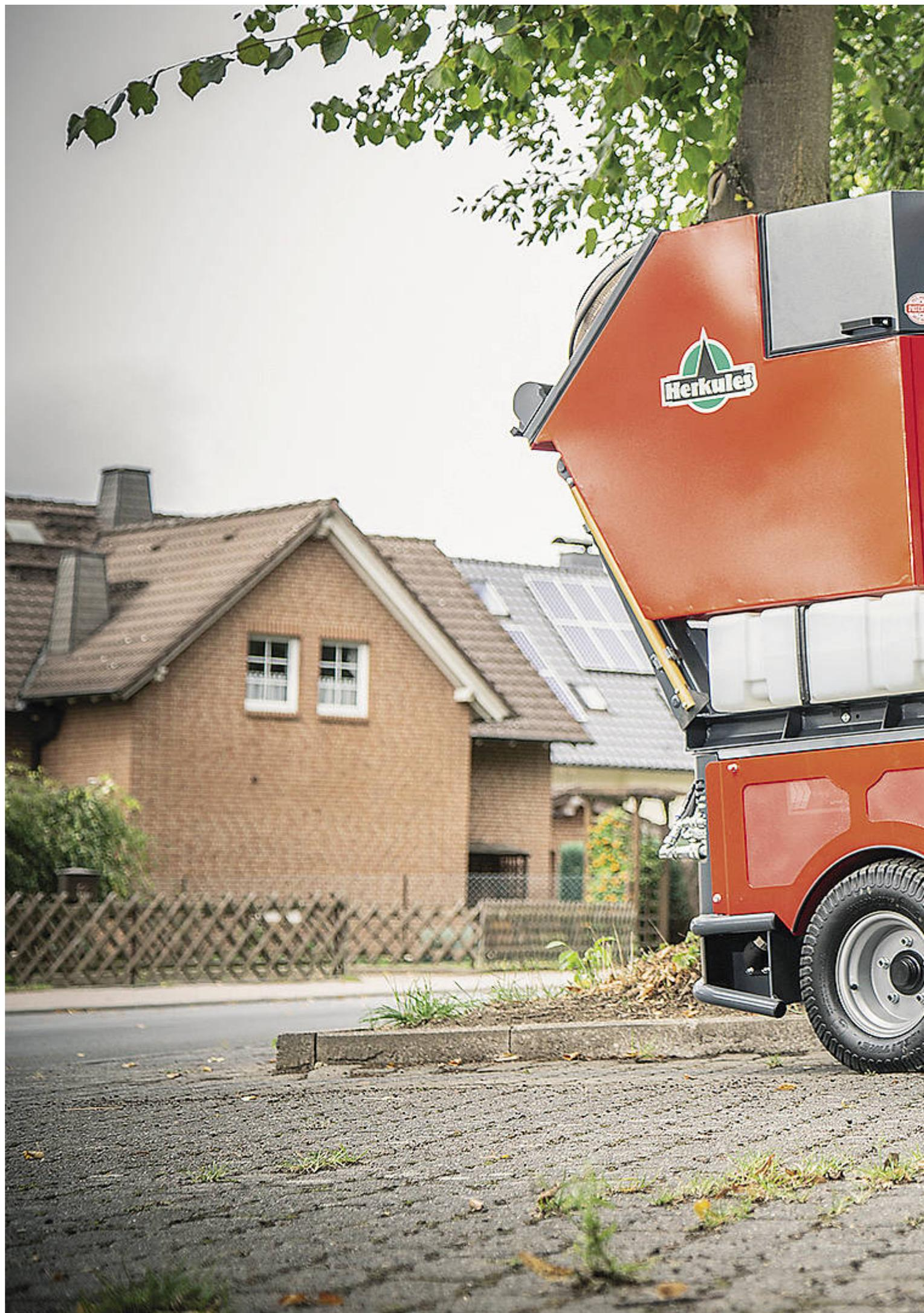
Die MPM 30D ist eine knickgelenkte Vielzweckmaschine von Telsnig/Herkules, die sich u.a. als Kehrmaschine einsetzen lässt.
