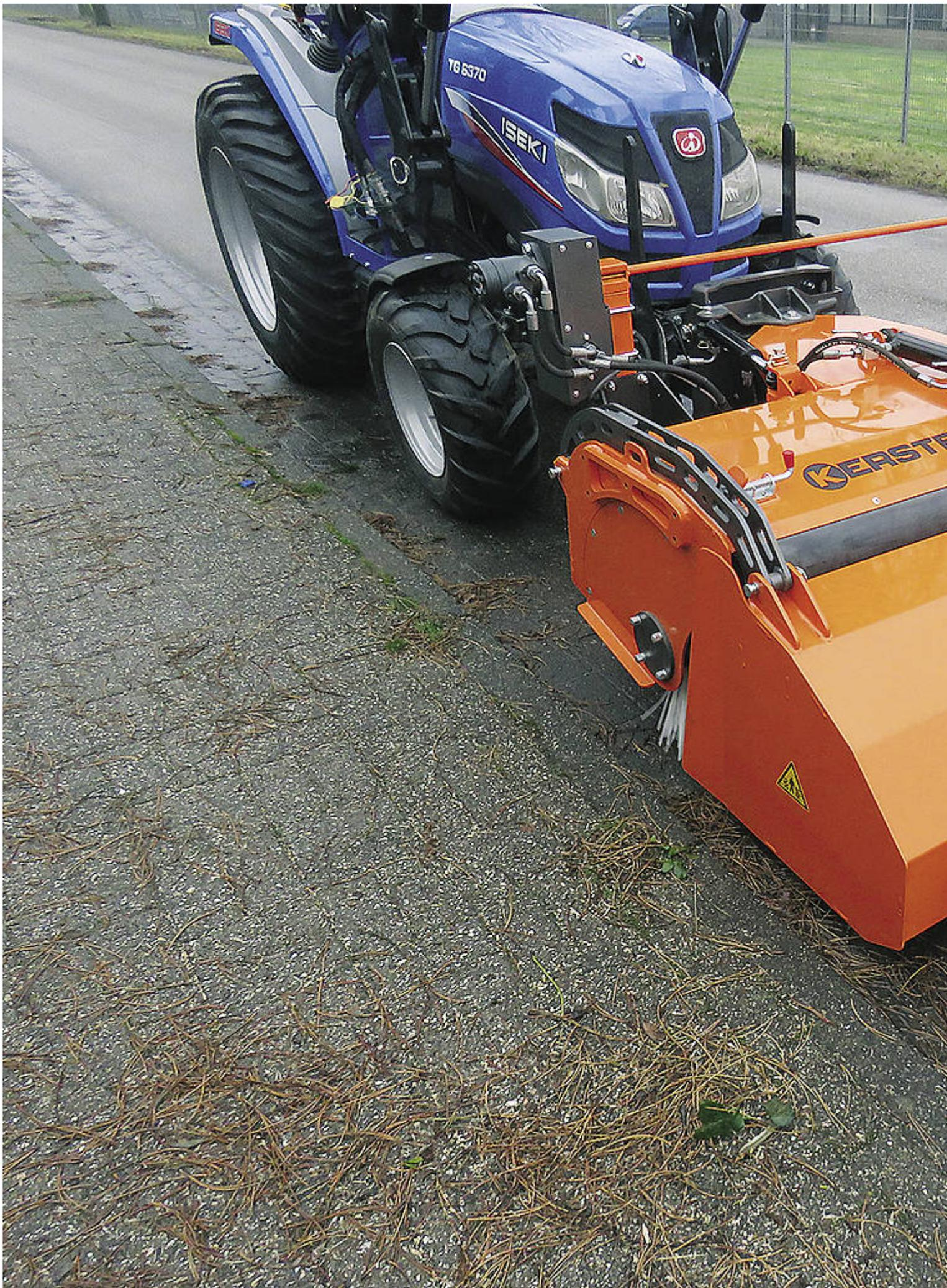
Mit 60 cm Walzendurchmesser ist die neue Frontkehrmaschine von Kersten auch für Kompakttraktoren geeignet.
