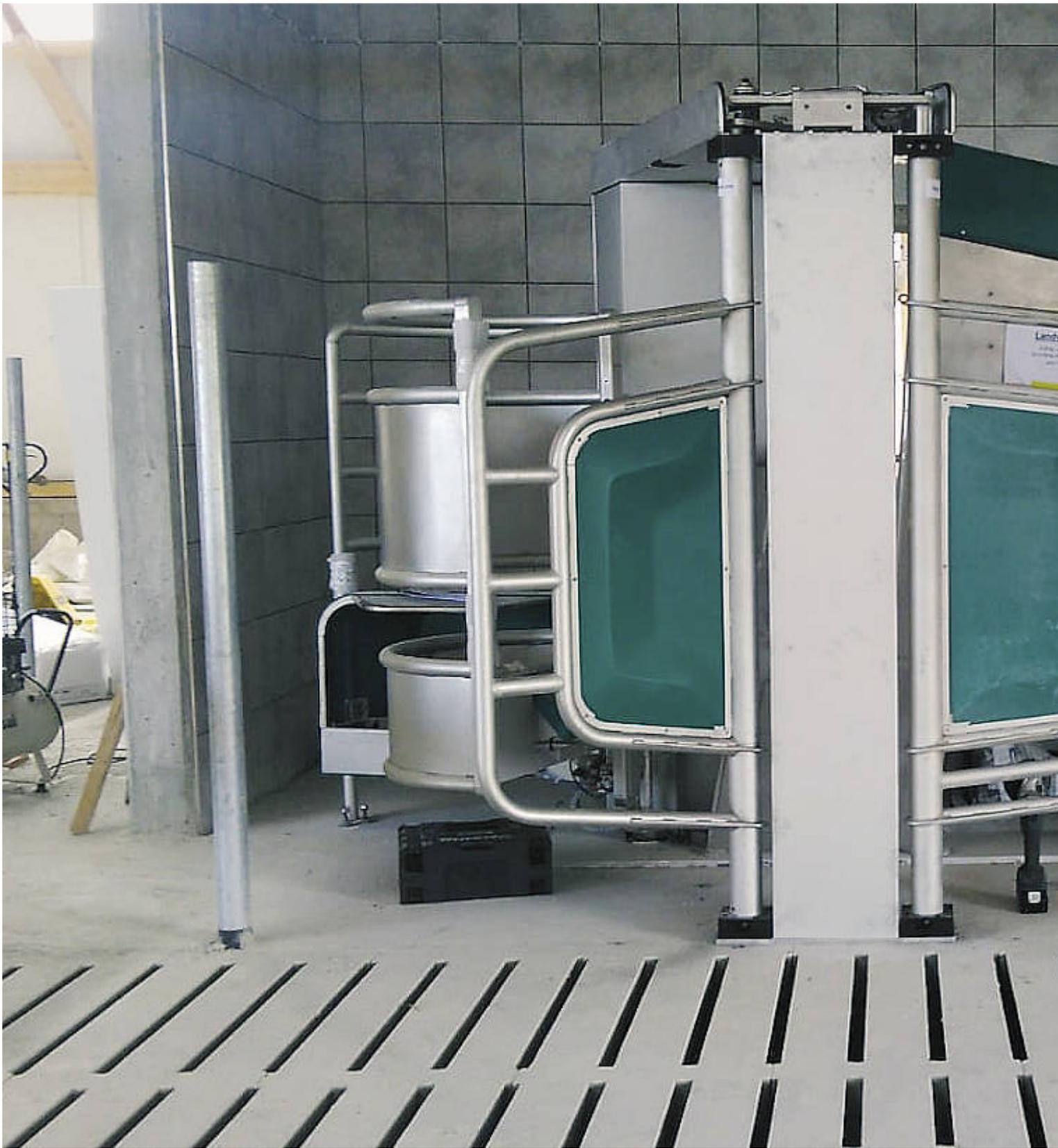
Montage des GEA Melkroboters Monobox.
