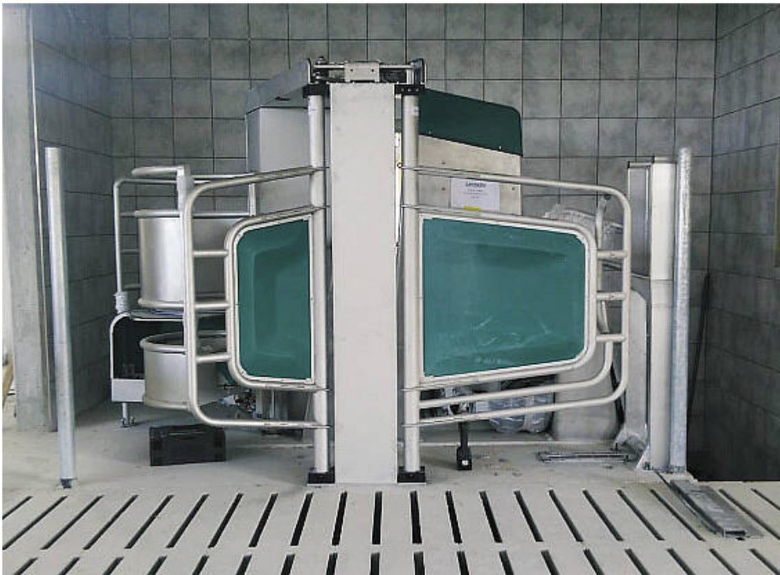
Montage des GEA Melroboters Monobox.
