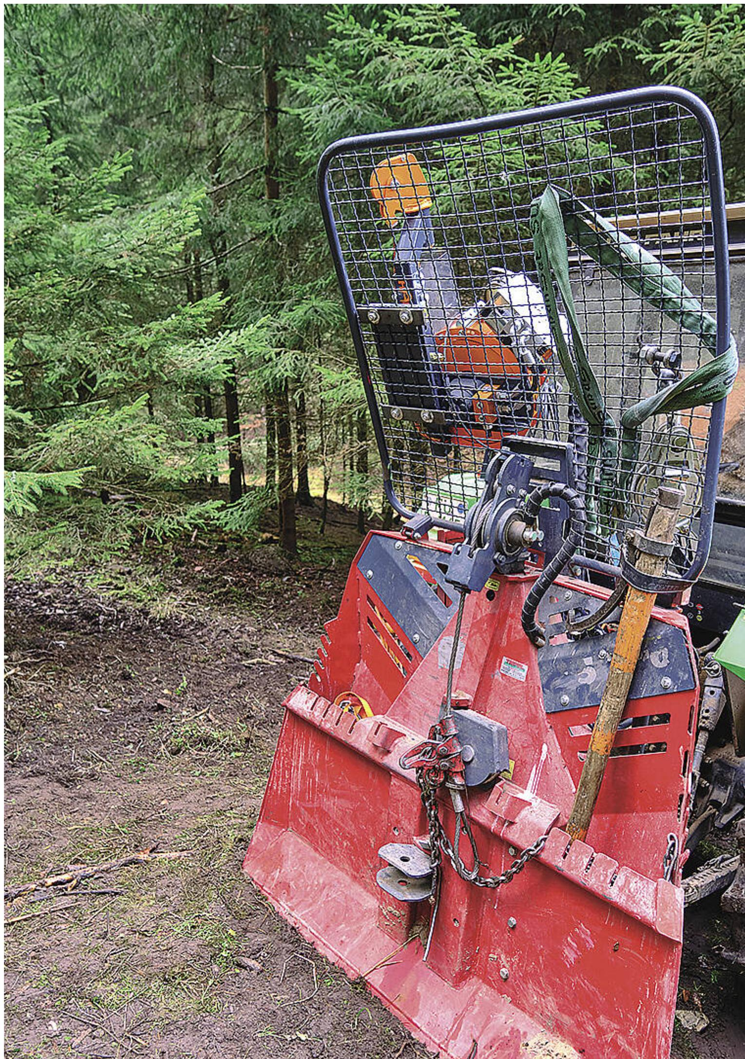
Die kräftige Winde konnte sogar das Gitter der Testwinde verbiegen.
