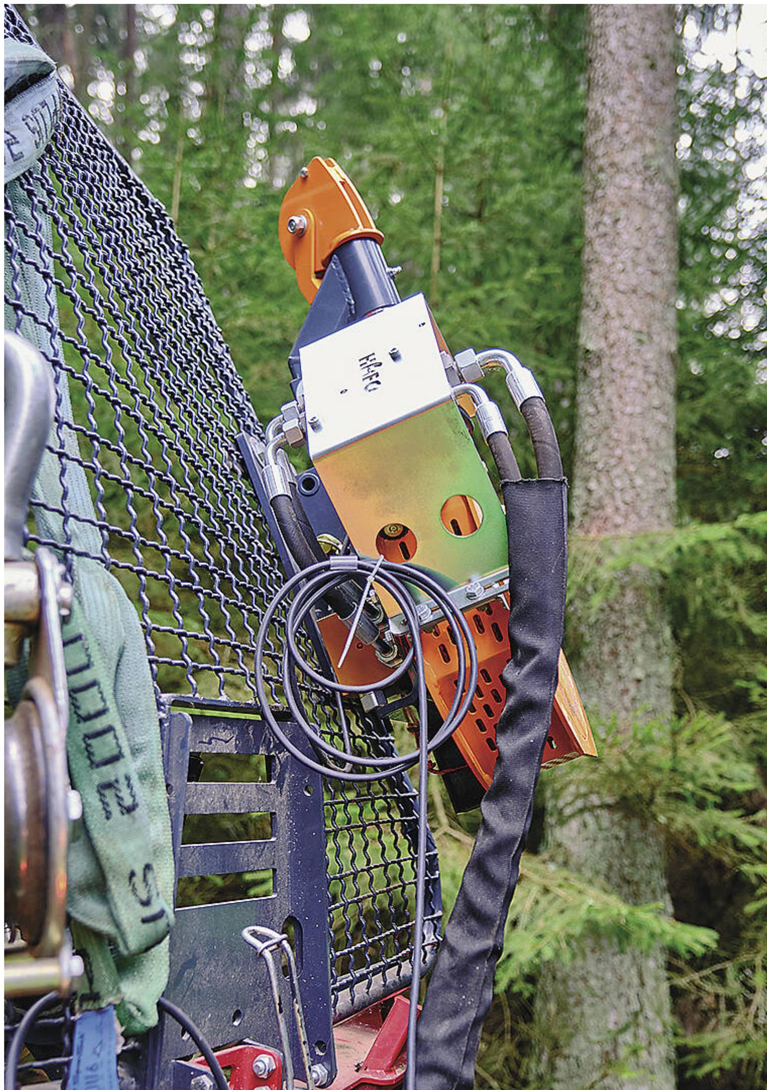
Die Installation ist einfach zu erledigen: Zwei Hydraulikleitungen und ein Kabel sind anzuschließen, zudem braucht es einen stabilen Platz für die tragende Wechselkonsole.
