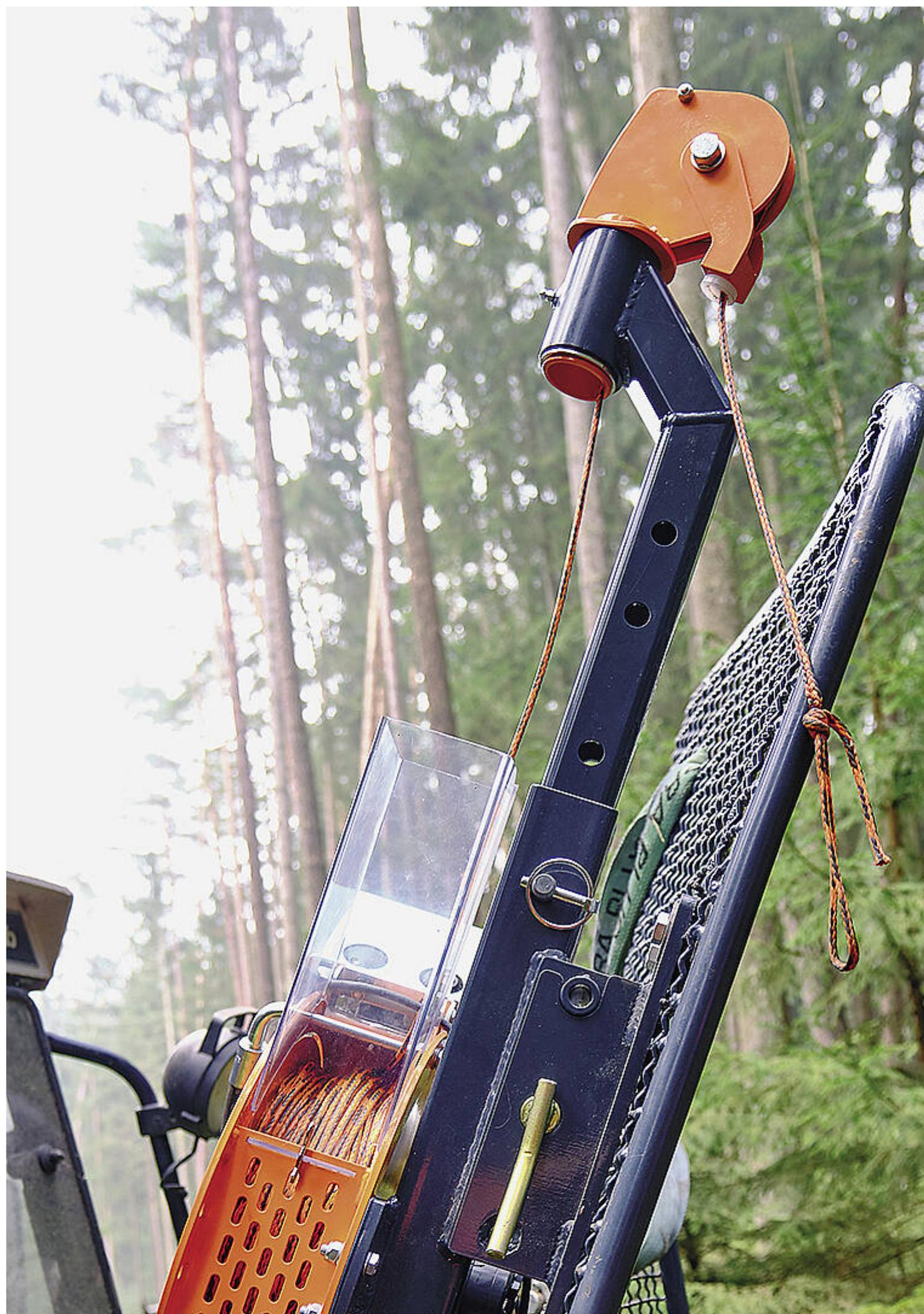
Der Turm mit Seileinlauf und Wippe kann durch einen Streckbolzen auf die nötige Höhe ausgefahren werden.
