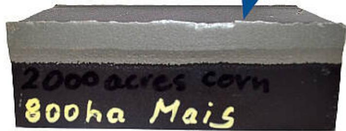
Durch schlechte Beschichtungsqualitäten kann der Vorteil einer aggressiven Schneidkante nicht ausgenutzt werden.
