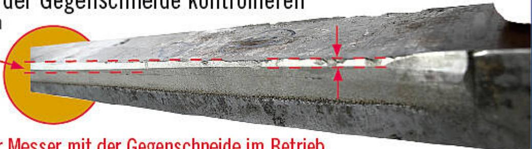
Durch starke Berührung der Messer mit der Gegenschneide im Betrieb
