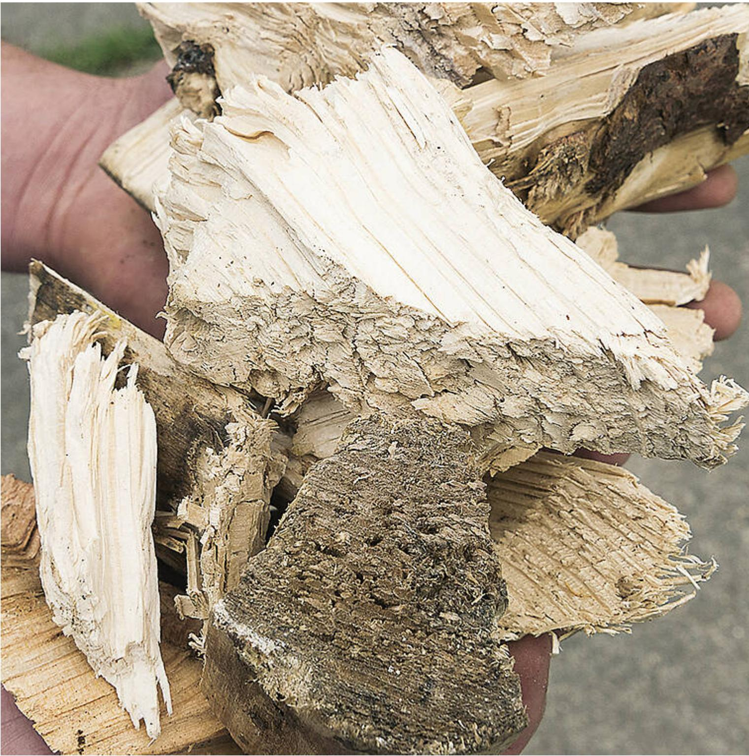
Die groben Hackschnitzel der Klassifizierung G 120 werden bei Betreibern größerer Biomasse-Heizkraftwerke nachgefragt.
