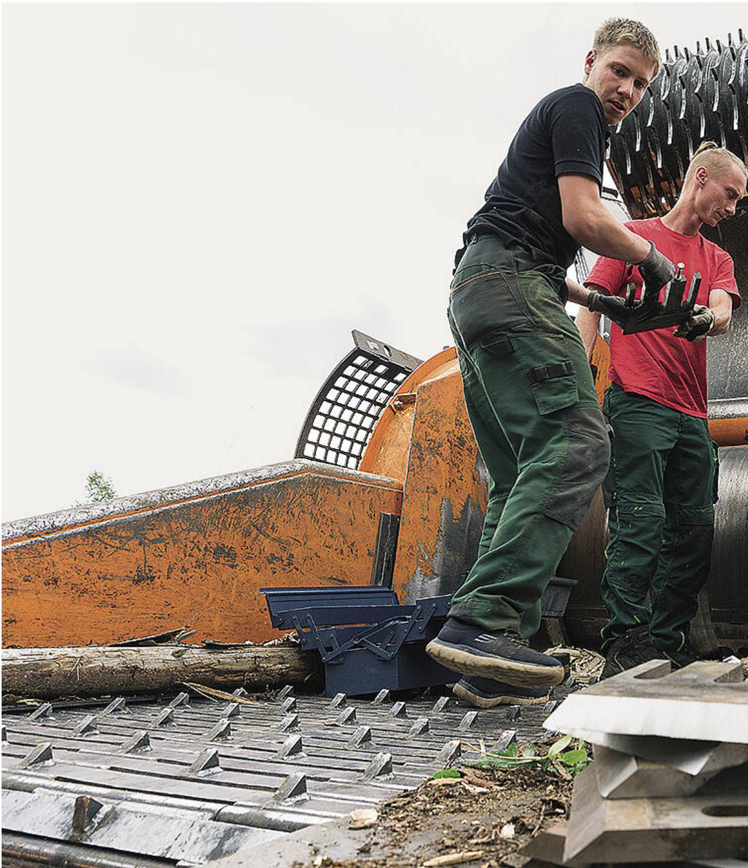
Um eine gleichbleibend gute Hackschnitzelqualität zu sichern, wird etwa alle acht Betriebsstunden der komplette Messersatz ge
