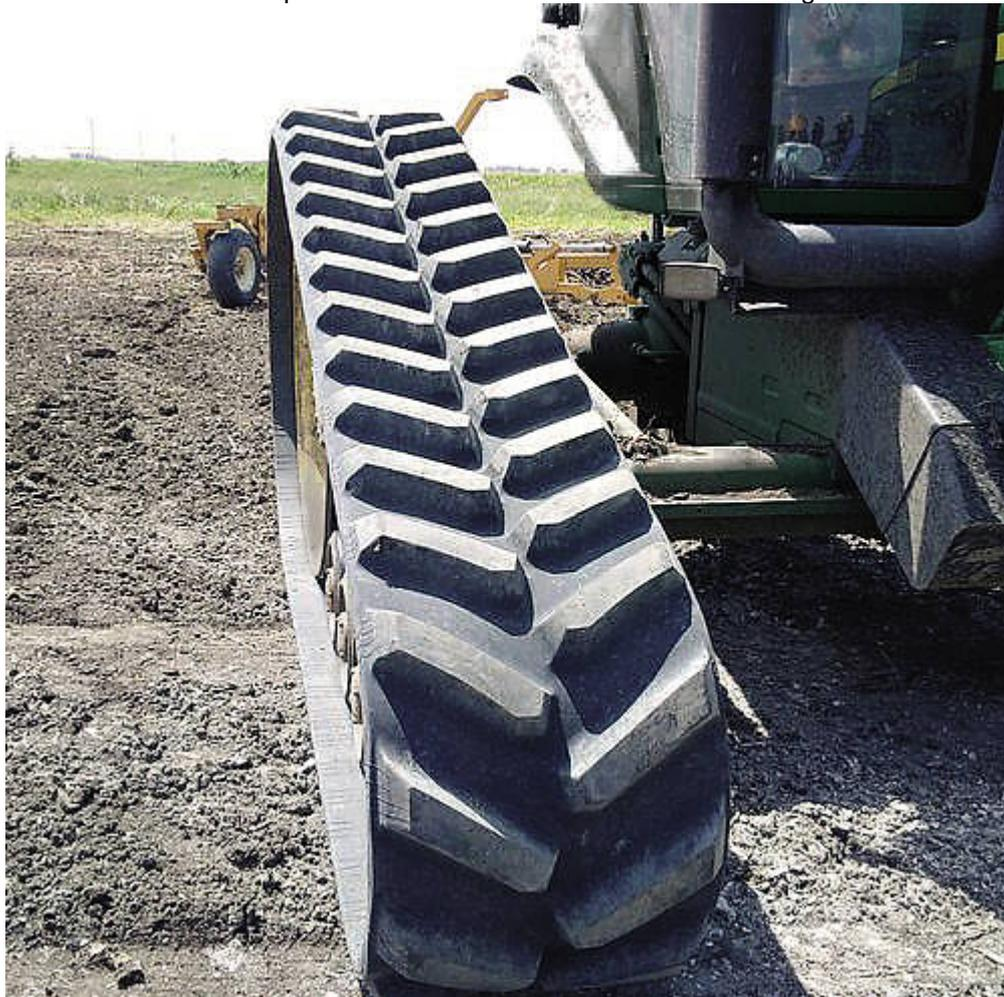
Die Gummiketten sorgen u.a. für eine bessere Verteilung des Maschinengewichts auf dem Boden.
