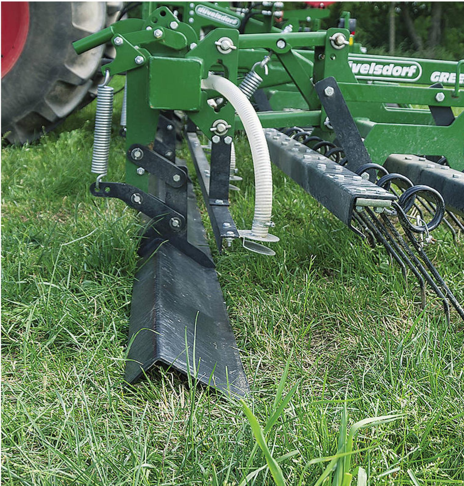
Der Gründlandstriegel Green.Rake von Düvelsdorf mit der über den Federdruck einstellbaren Einebnungsschiene und den einzelnen Zinkenabstand.
