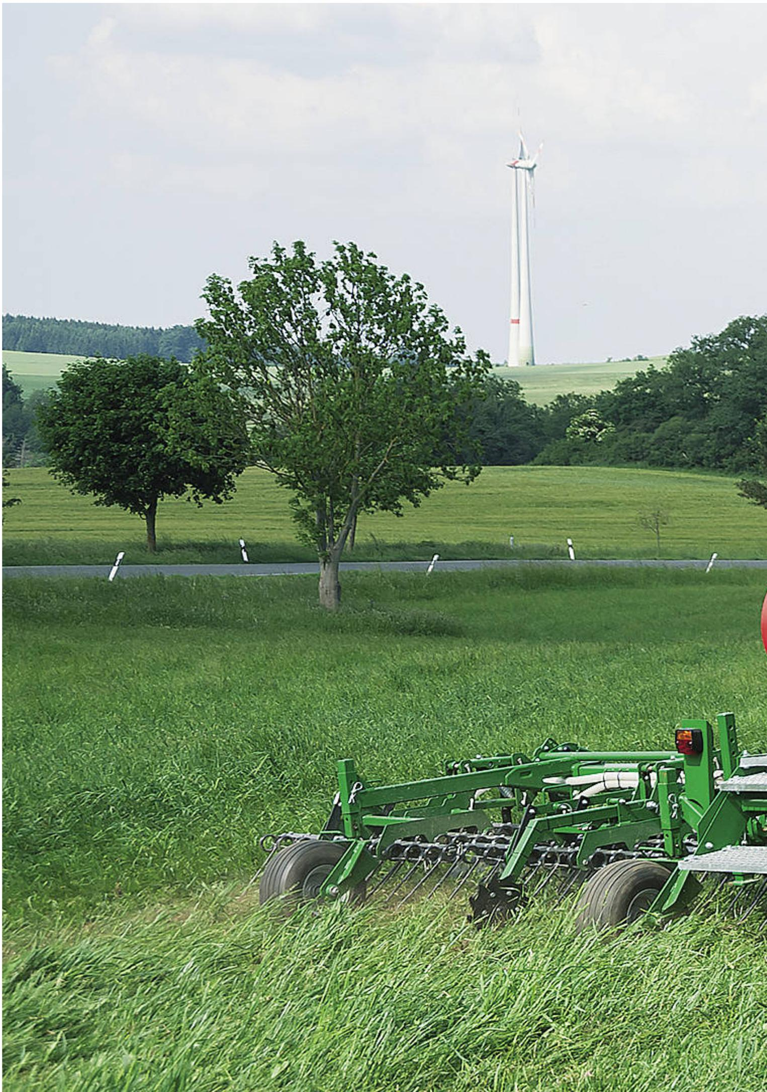
Die sensorgesteuerte Säeinheit auf dem Grünlandstriegel Green.Rake von Düvelsdorf dosiert die Saatgutmenge entsprechend der Bestandsdichte.
