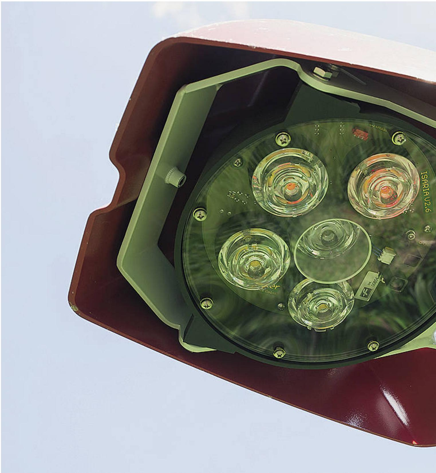
Sensorkopf des Isaria von Fritzmeier mit zwei Infrarot- und zwei Normallicht-LED sowie dem mittig sitzenden Detektor.
