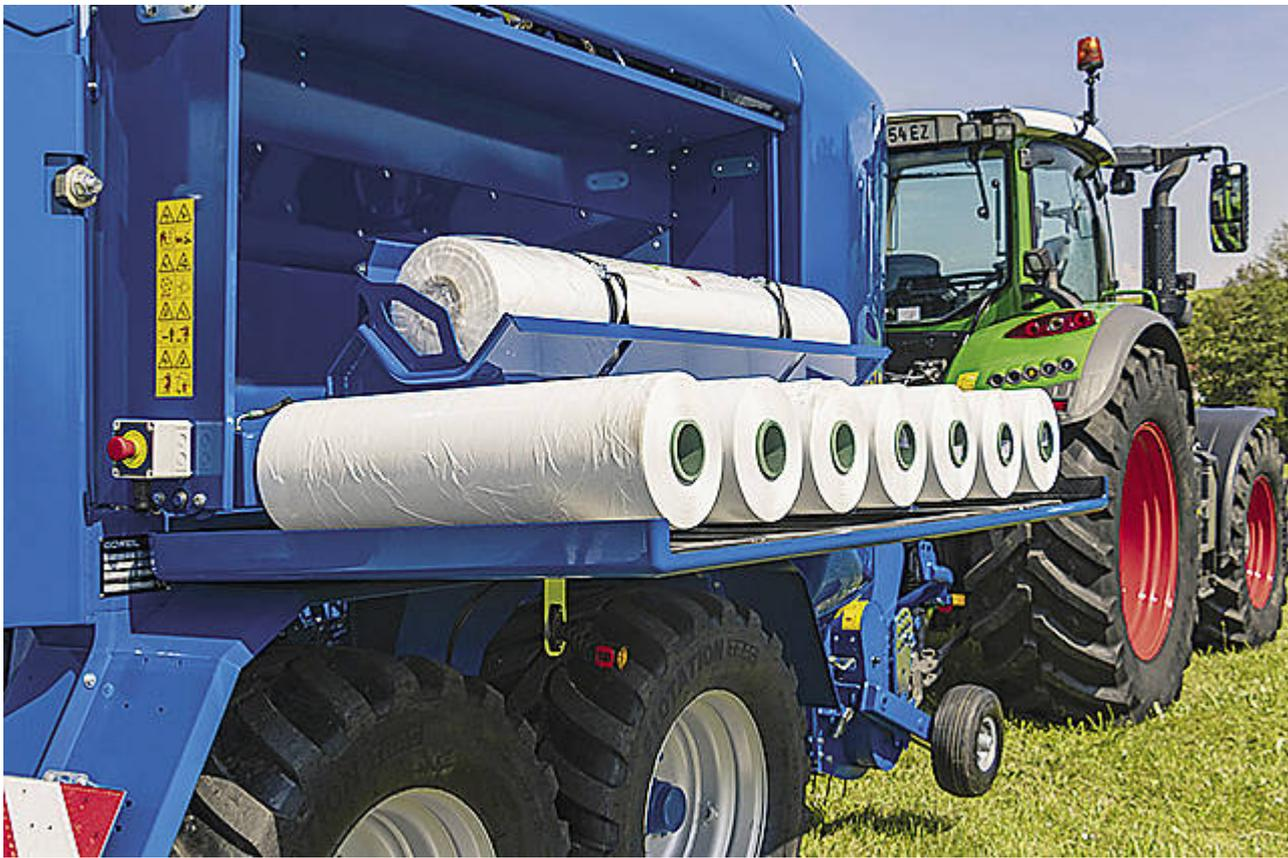
Im geschlossenen Folienmagazin können nun 14 Rollen Wickelfolie und 2 Rollen Mantelfolie verstaut werden.
