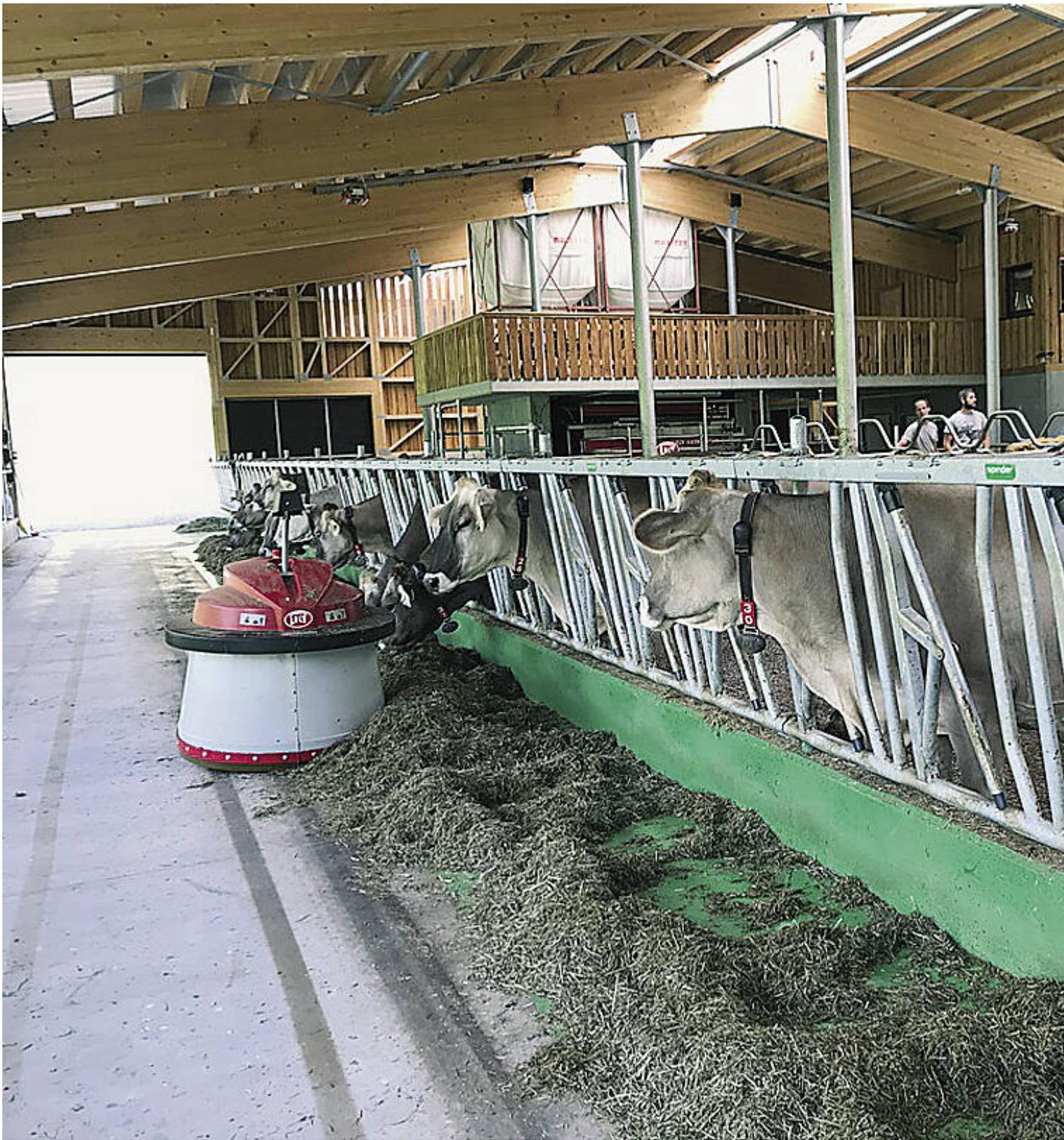
Automatische Futteranschieber sind in der Regel akkubetrieben.
