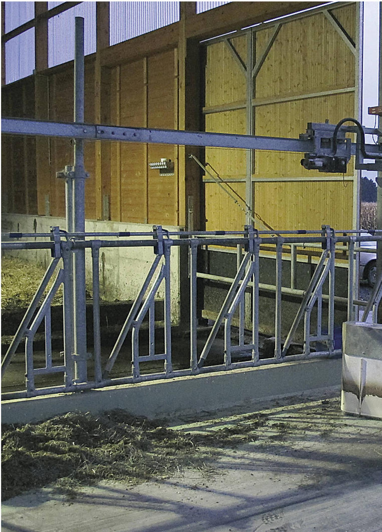
Der akkubetriebene Butler Silver der Firma Wasserbauer ist an einer oberhalb des Fressgitters angebrachten Laufschiene befestigt und fährt mittels Stützrad auf dem Boden.
