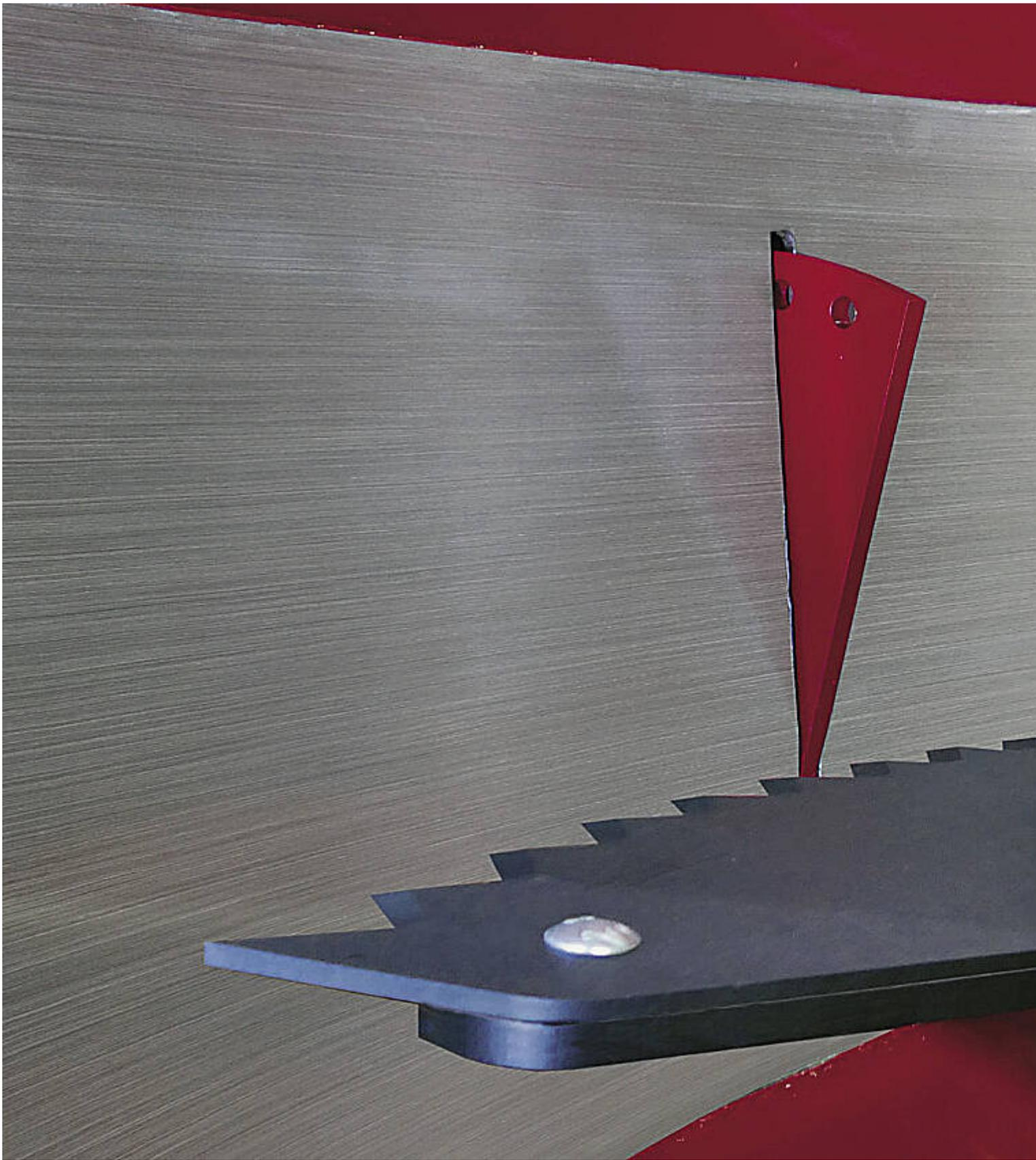
Die Edelstahlauskleidung der Mischwanne schützt ebenso wie die Edelstahlaufpanzerung der Mischschnecke vor Verschleiß. Die Mischwanne ist ein Material.
