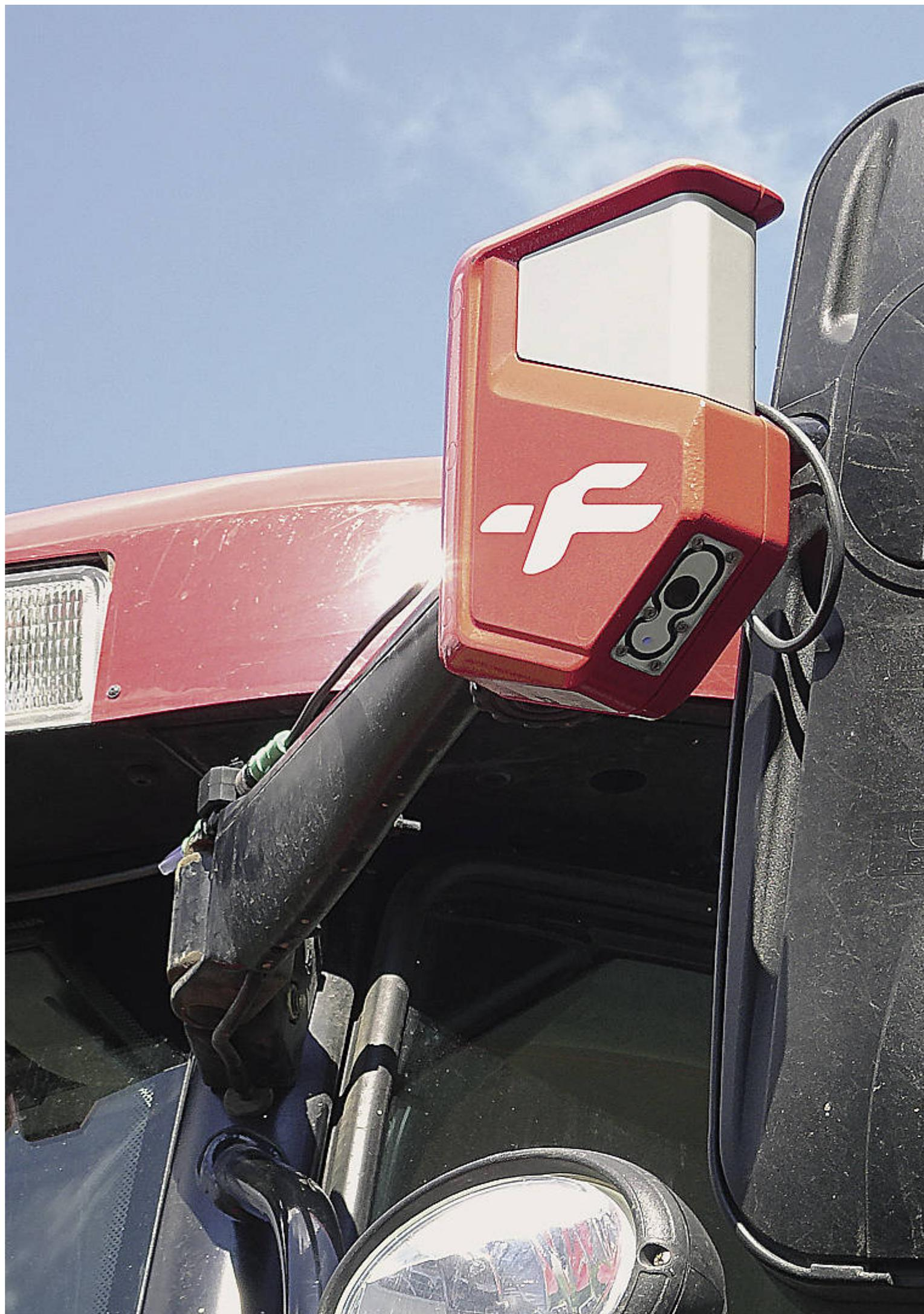
Der Isaria Basic besteht aus Pflanzensensoren an den Rückspiegeln, die die Lichtreflexion des Bestandes messen, einem Referenzsensor auf dem Dach, der die Intensität des Tageslichts erfasst, sowie einem Isobus-Terminal.
