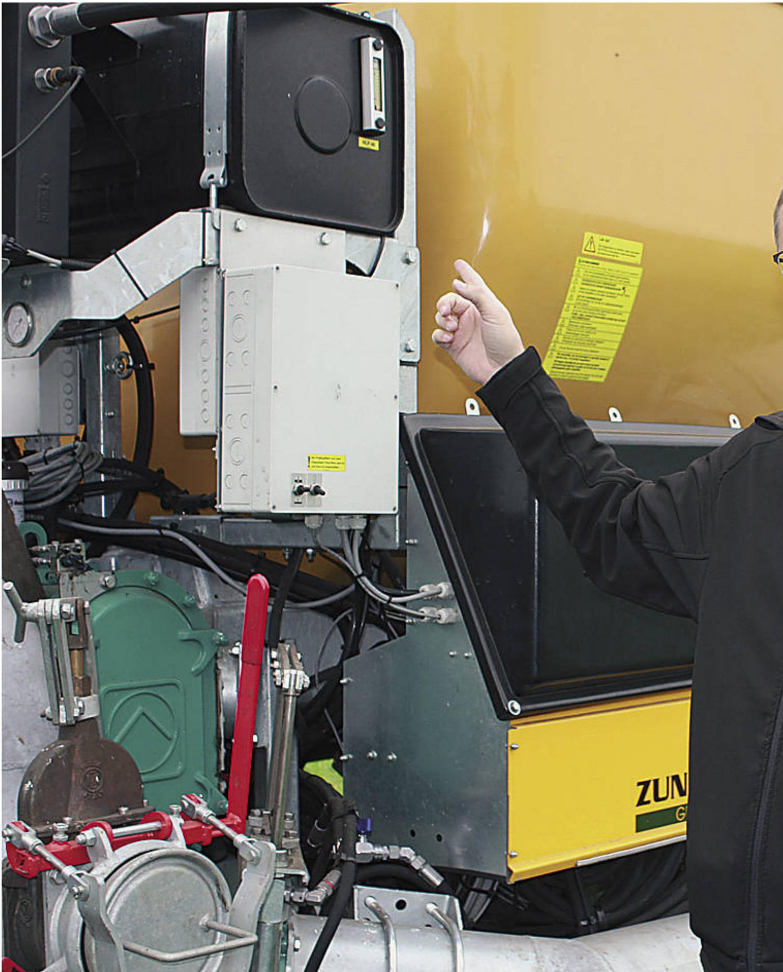
Sebastian Zunhammer: „Beim Befüllvorgang misst der NIR-Sensor die Inhaltsstoffe der Gülle im Millisekundenbereich.“
