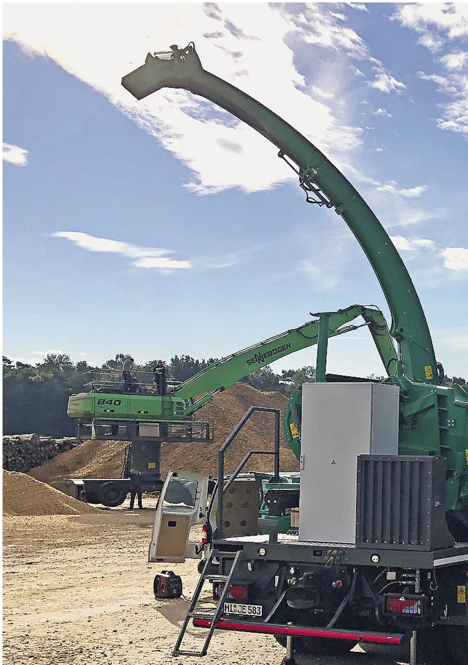
Im finalen Test hat sich gezeigt, dass durch den Hybrid-Antrieb im Vergleich zu einem herkömmlichen Modell 20 Prozent Diesel gespart werden kann.
