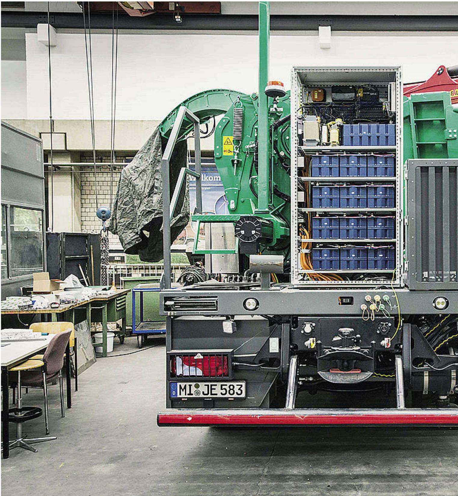
Überschüssige Energie wird in 13 sogenannten Superkondensatoren (Mitte) gespeichert und kann im Boost-Modus wieder genutzt werden.
