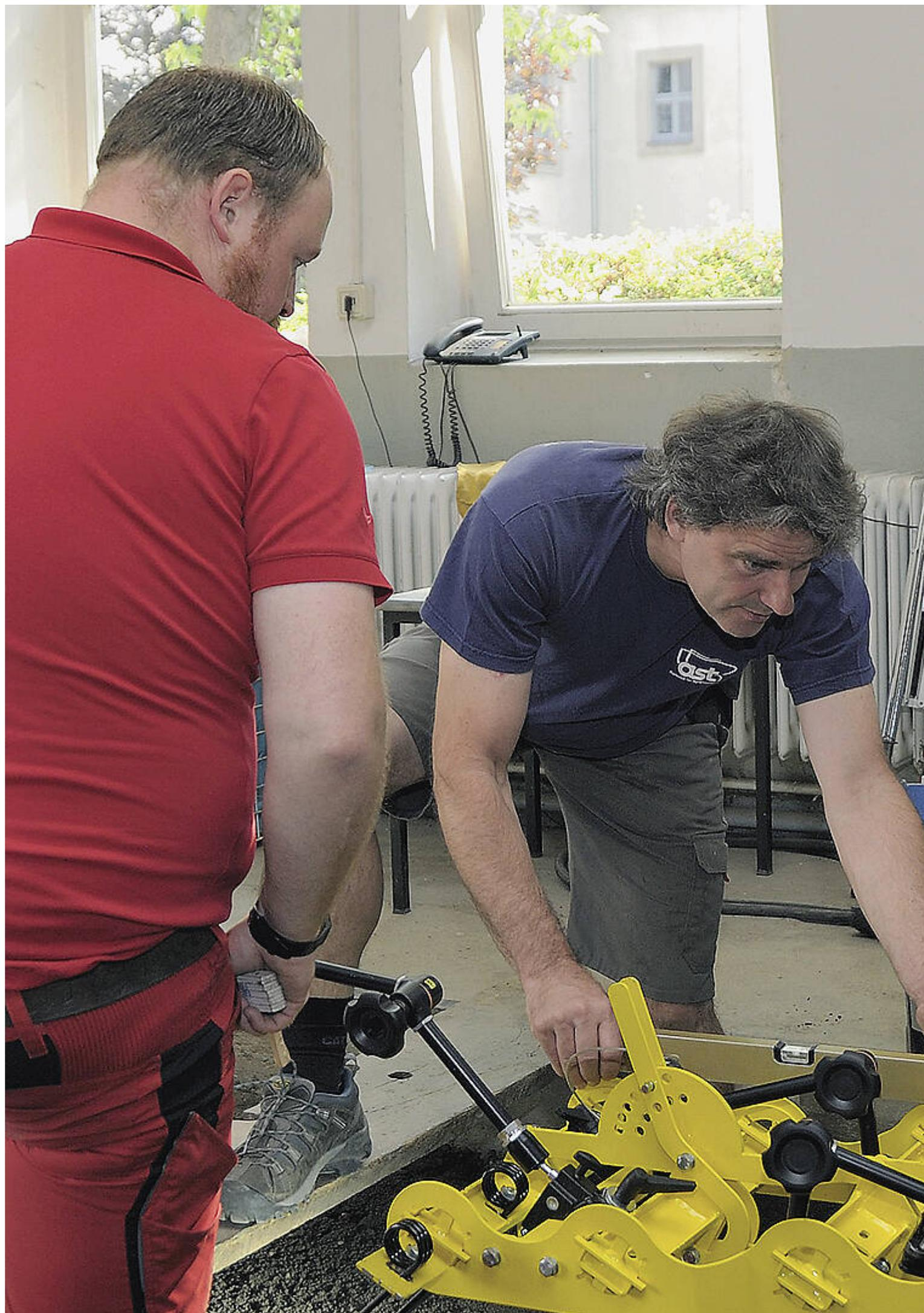
Das genaue Justieren der Werkzeugaufnahme am Messwagen der Bodenrinnenanlage ist Voraussetzung für vergleichbare Ergebnisse der Striegeltests und erforderte oft die Mitwirkung des gesamten Teams.
