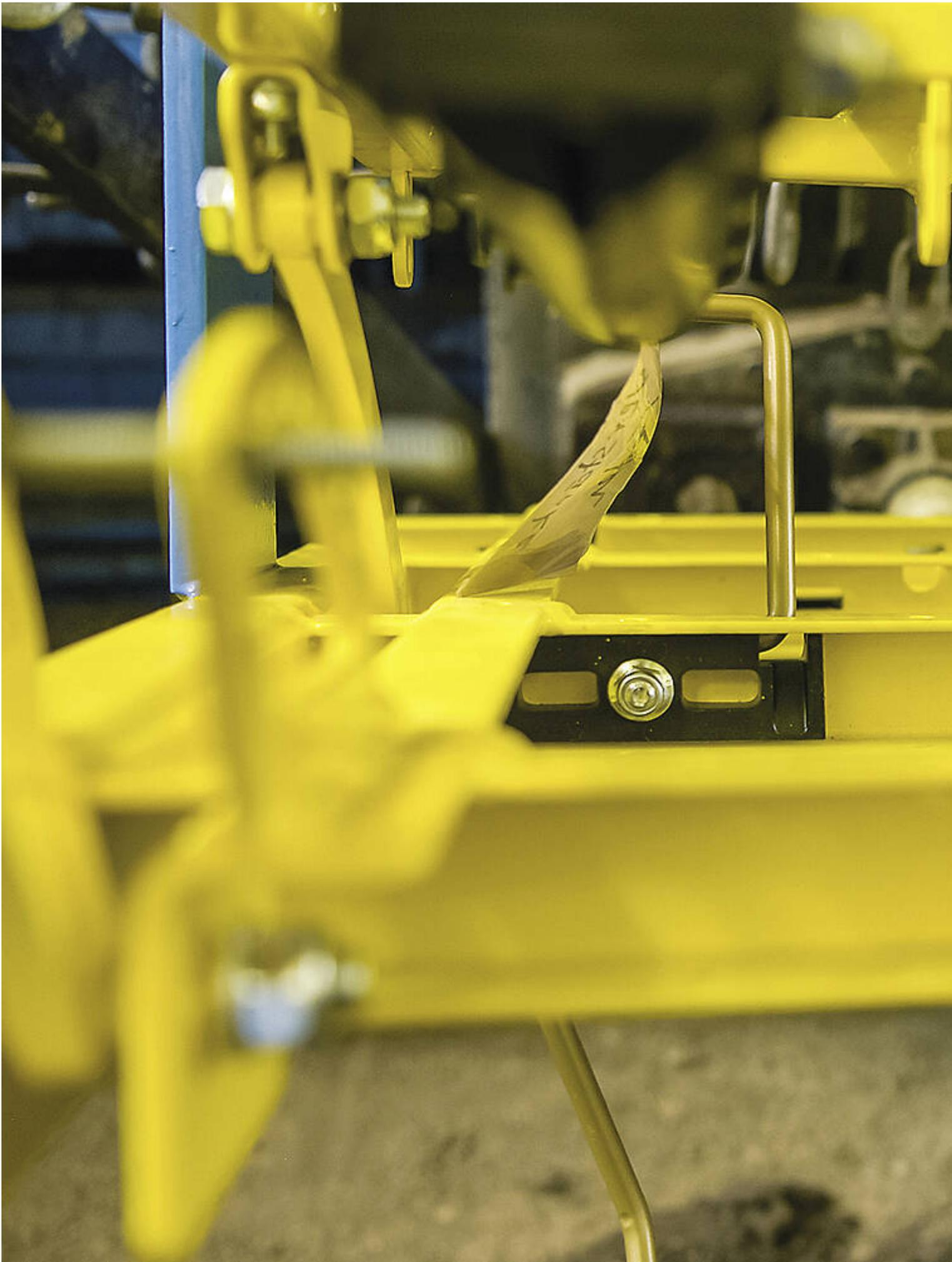
Beim Variostriegel von APV sitzen die Zinken nach dem Prinzip des Scharnierbolzens am unteren Rahmen und sind mit dem ob
