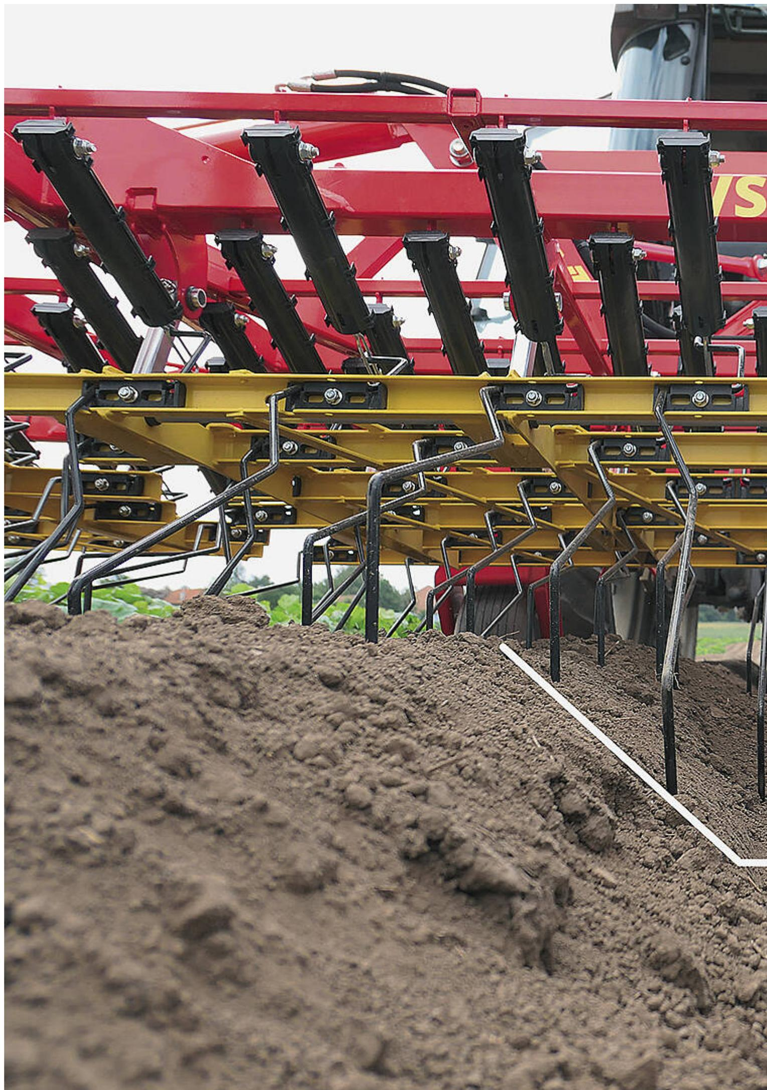
Mit dem Federnpaket von APV (oben schwarz) ist es möglich, auch auf Kartoffeldämmen alle Oberflächen mit demselben Zinkendruck zu bearbeiten. Aber auch in anderen Kulturen kann der Zinkendruck präzise eingestellt werden.
