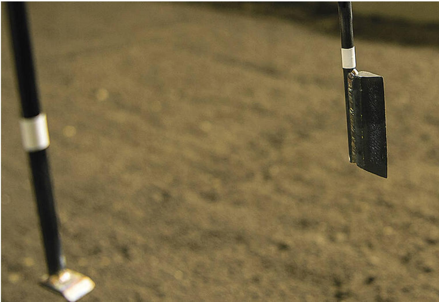
Auf der Bodenrinnenanlage testete das APV-Entwicklerteam auch Striegel mit speziellen Werkzeugspitzen für die Bodenbearbeitung.
