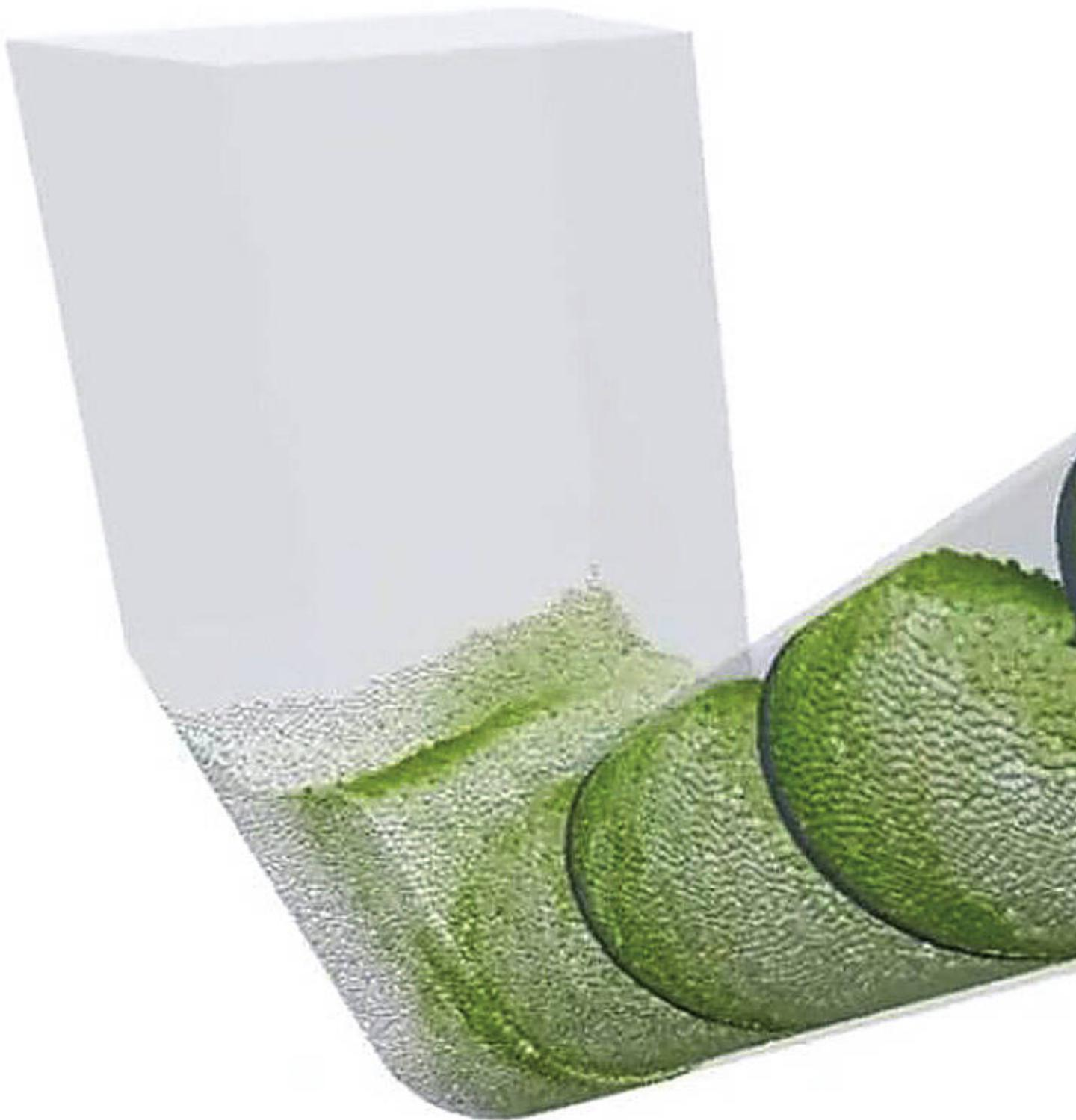
Bei der Auslegung von Förderschnecken im Kornbunker und Überladerohr ermöglicht die Simulation der Partikelströme am Com
