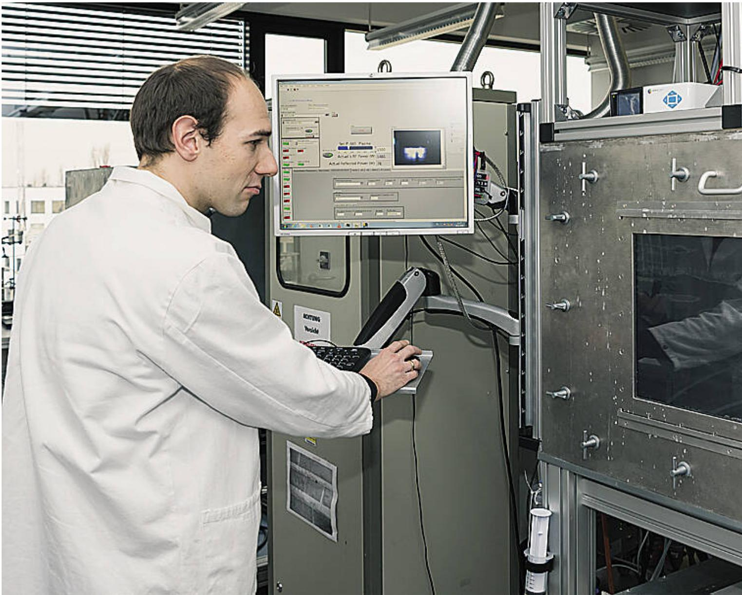
Dr. Simon Schneider überwacht am Plasmalyzer im Entwicklungslabor von Graforce den Prozessablauf der Dissoziation von sch Wasserstoff.
