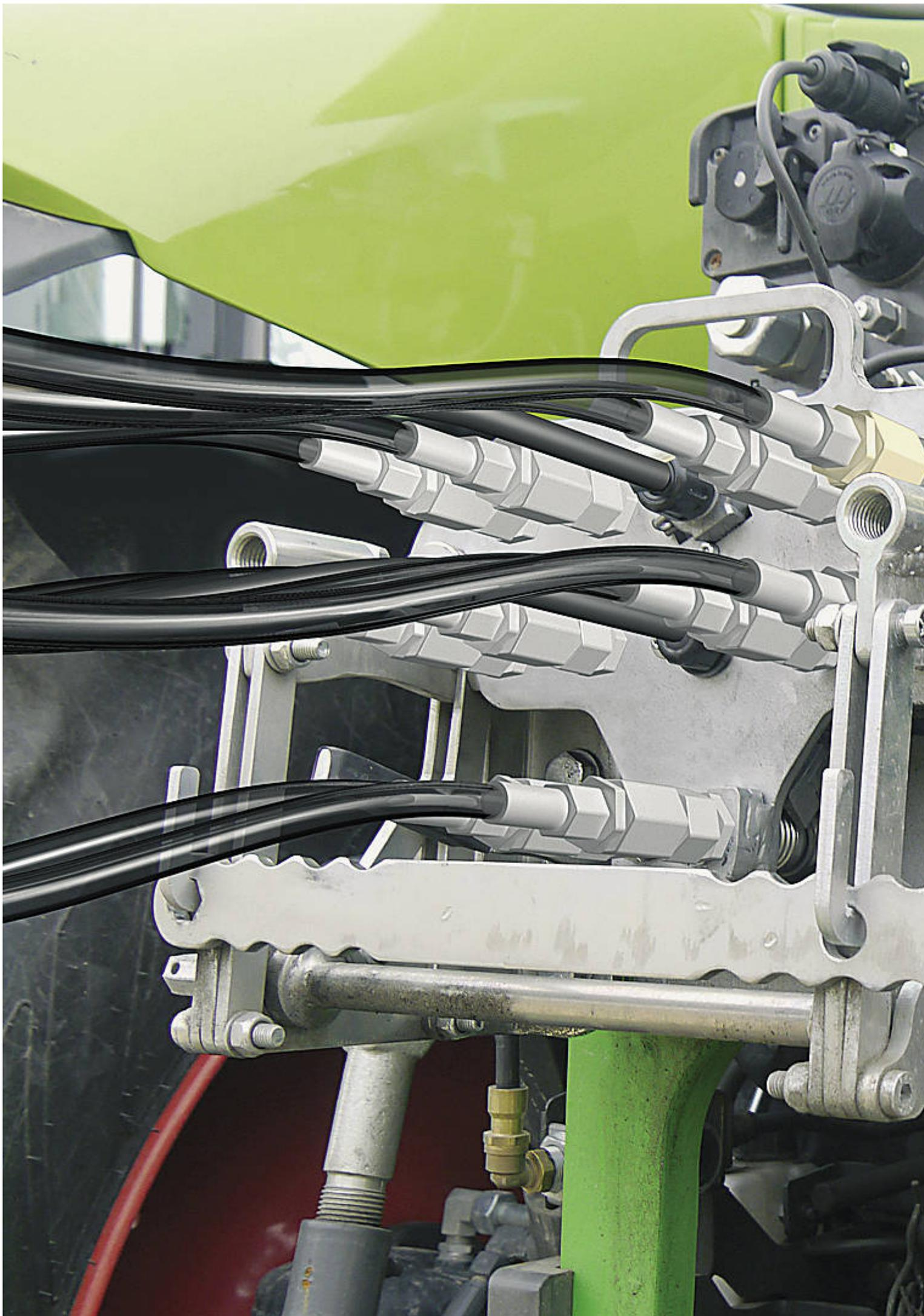
An der Bedieneinheit sind alle Leitungen vertauschsicher befestigt.
