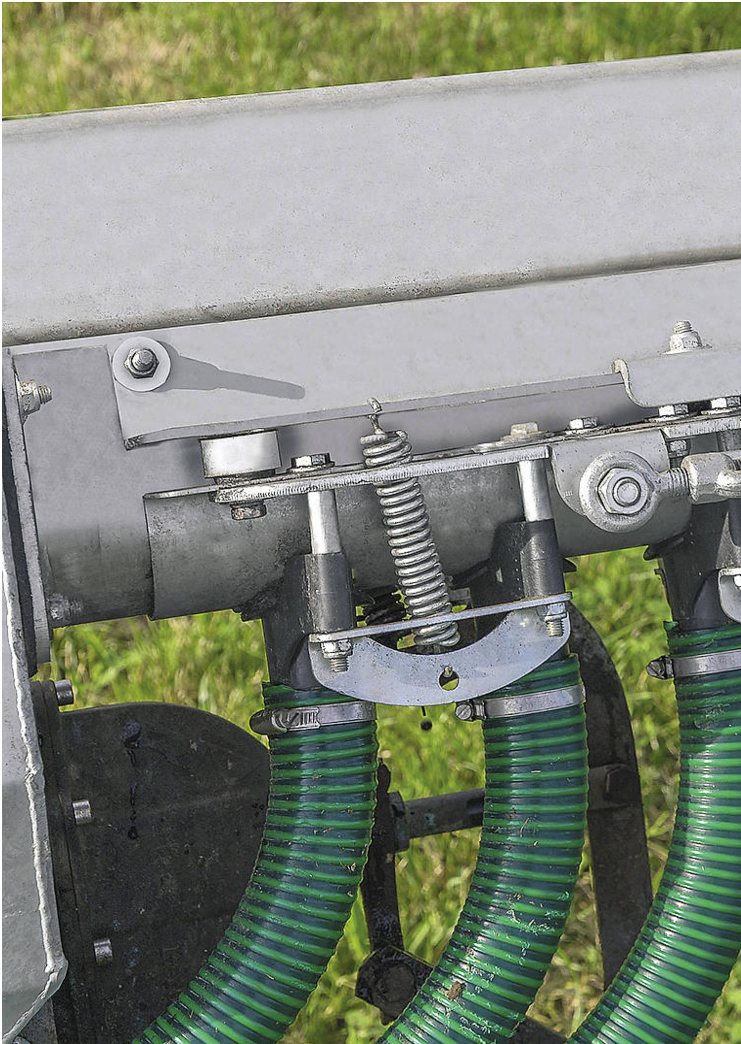
Die Verstellung des FlexFlow erfolgt über eine mechanische Spindel.
