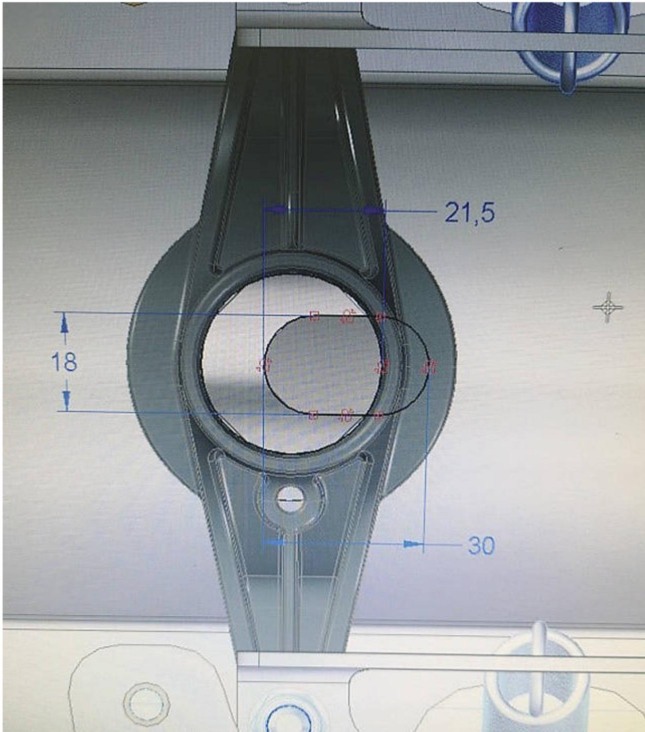
Die Unterwanne ist zur Ausflussregulierung der Gütle in Längsrichtung der Fördervorrichtung relativ zum Förderschneckenbehälter verschiebbar.
