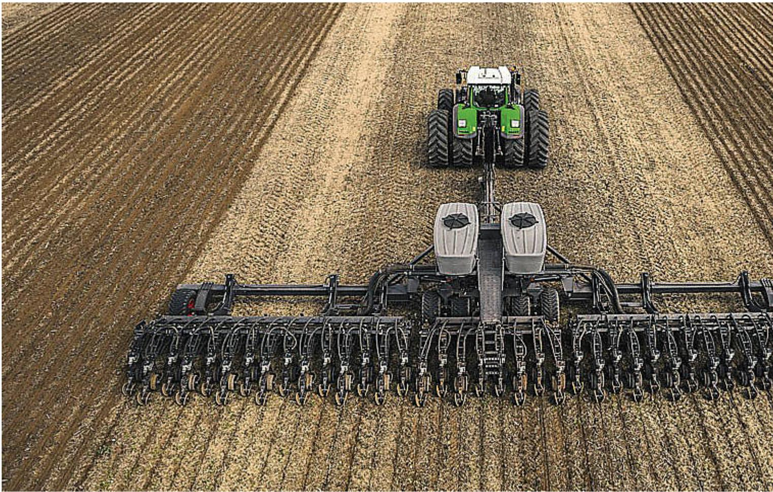
Die Sämaschine nutzt für die exakte Düngerausbringung vApply Granular – eine Technik von Precision Planting.
