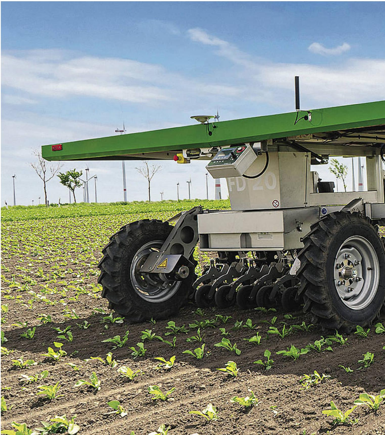
Der FarmDroid-Roboter FD20 ist mit GPS-Saatsystem, Hackgerät und dem Feldspritzensystem für Spotapplikationen von Amaz
