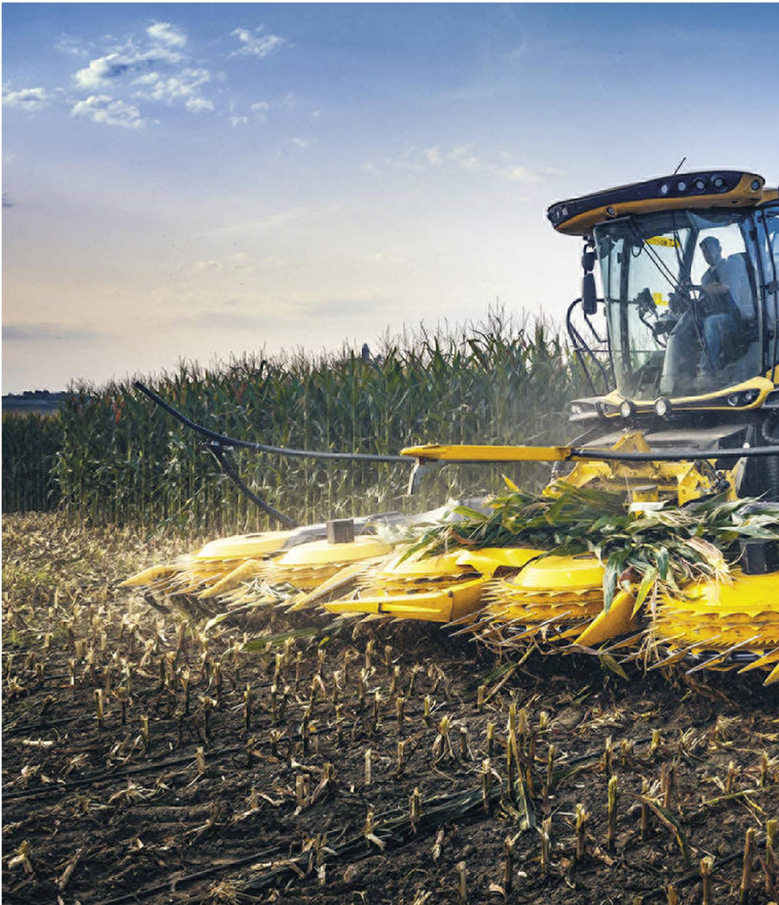
Im Test eingesetzt: New Holland FR 780 mit zwölftreihigem Vorsatz Kemper 900 BFI.
