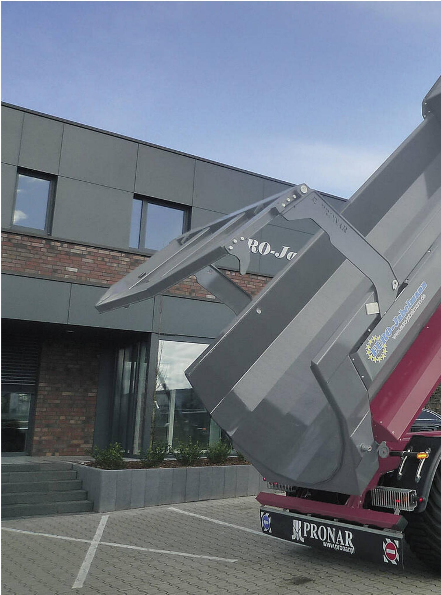
Der Hubzylinder hat eine Länge von 4.670 mm, der Kippwinkel beträgt 55°.
