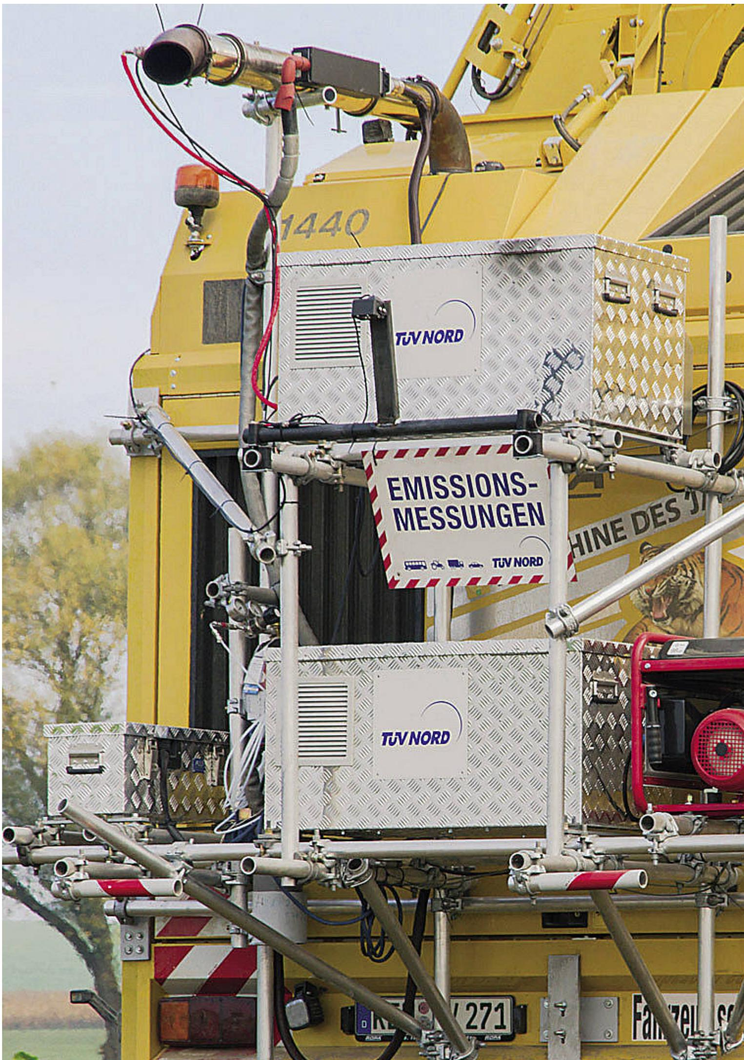
Das Equipment für die mobile Abgasprüfung von Non-Road-Maschinen wiegt einschließlich Stromaggregat mehr als 100 kg. Oben links das Ansatzrohr mit Massenstrommesser und Ableitung von Motorgase zu den Analysegeräten.
