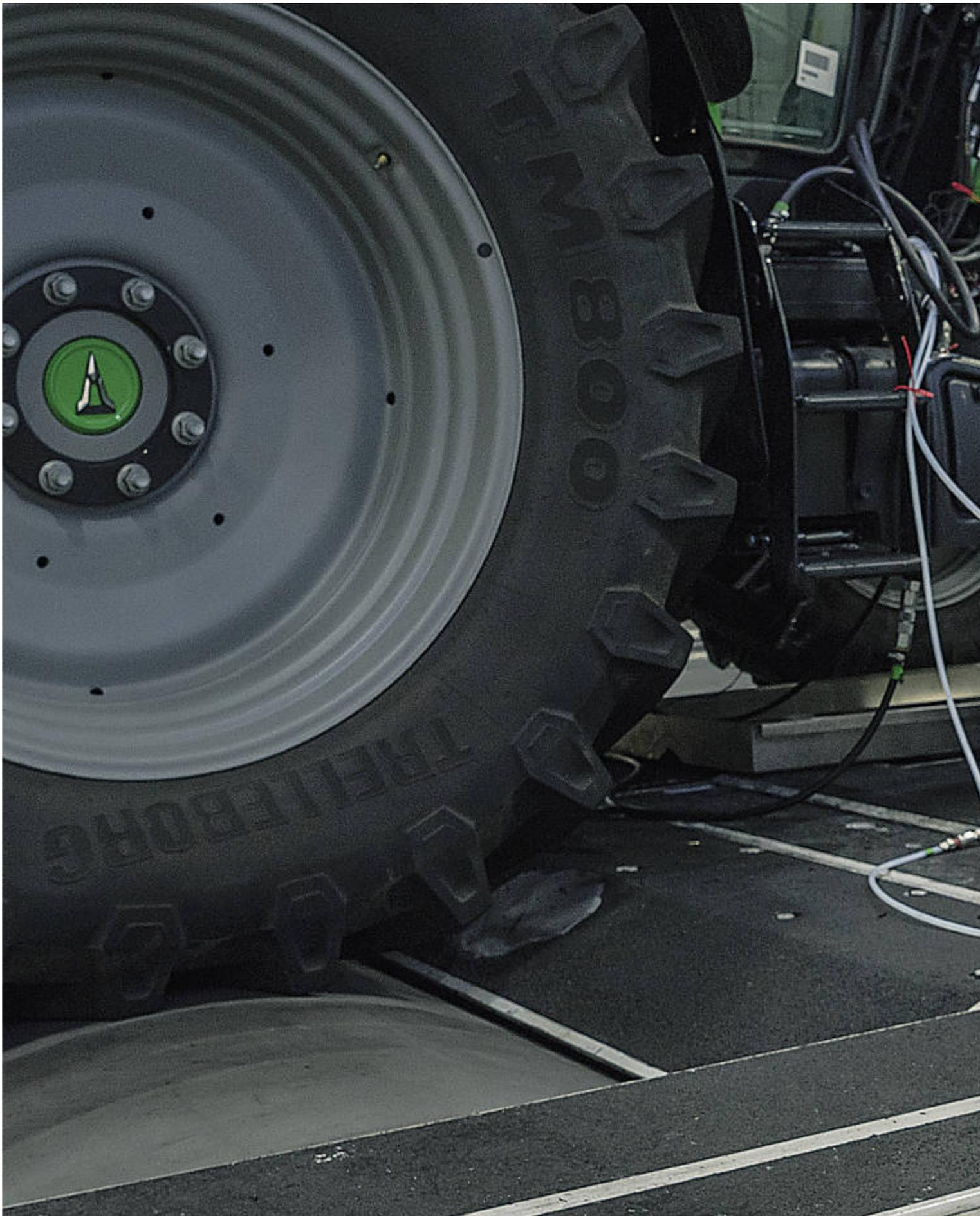
Messgerät für den AdBlue-Verbrauch auf dem DLG-Rollenprüfstand. Die Erfassung gehört seit Einführung der Abgasstufe IV sta
