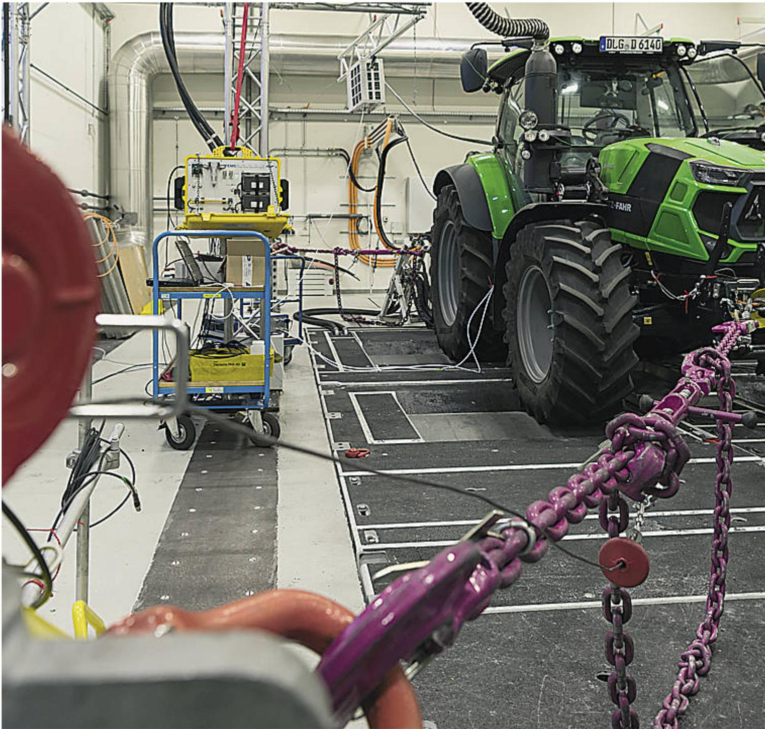
Pro Woche wird im Schnitt ein Traktor auf dem Prüfstand getestet. Fahrwerk als auch Zapfwelle und Hydraulik lassen sich dabei
