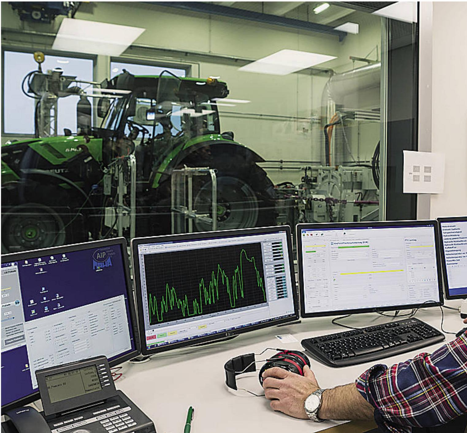
Fahrzeugtechnik-Ingenieur Hans-Joachim Tauber in der Steuer- und Messzentrale des Rollenprüfstandes im DLG-Testzentrum.
