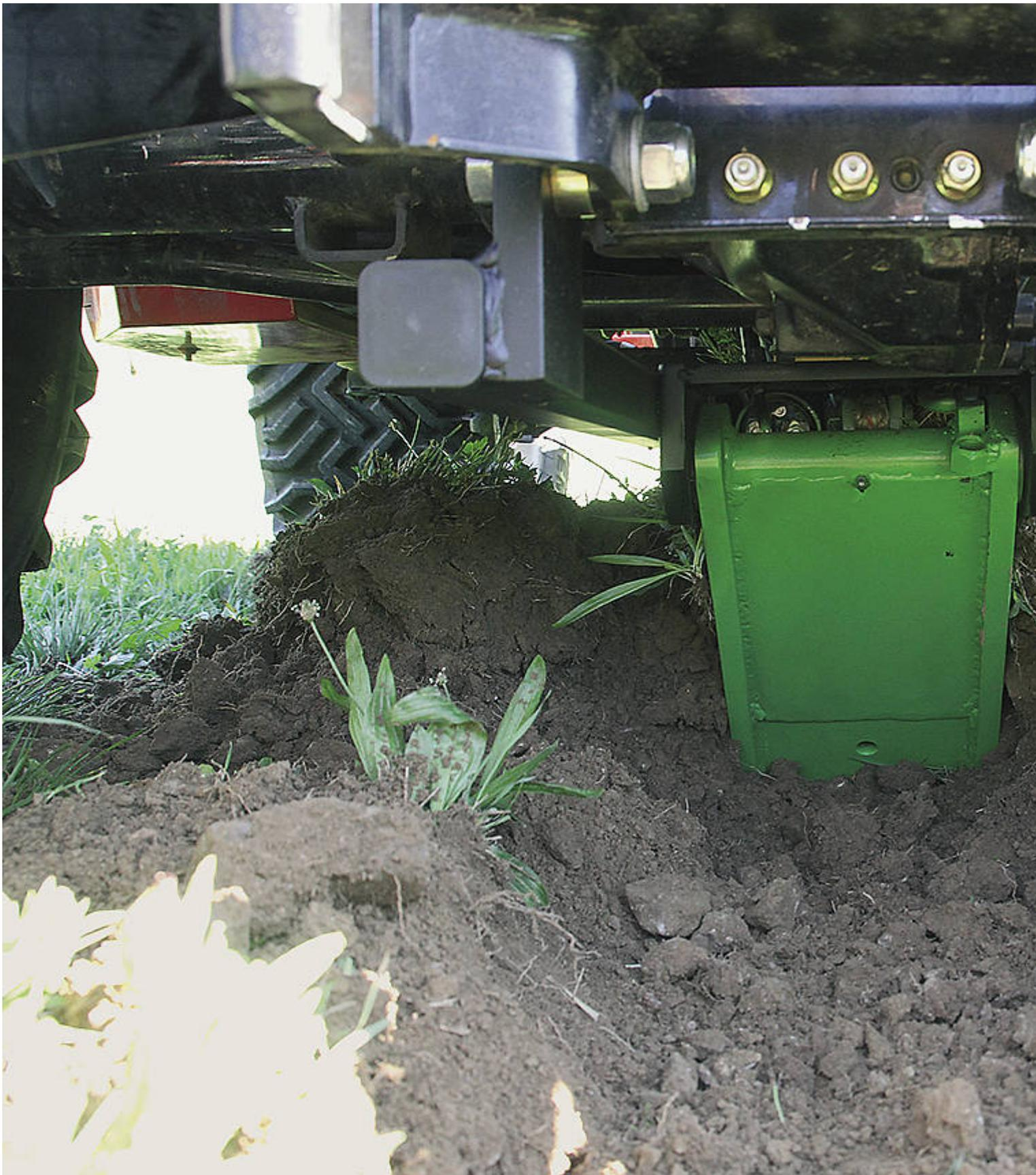
Die Bergung eines mit „SlipGuard“ abgebremsten Fahrzeuges kann etwas aufwändig sein, da sich das System mit Dreck füllt.
