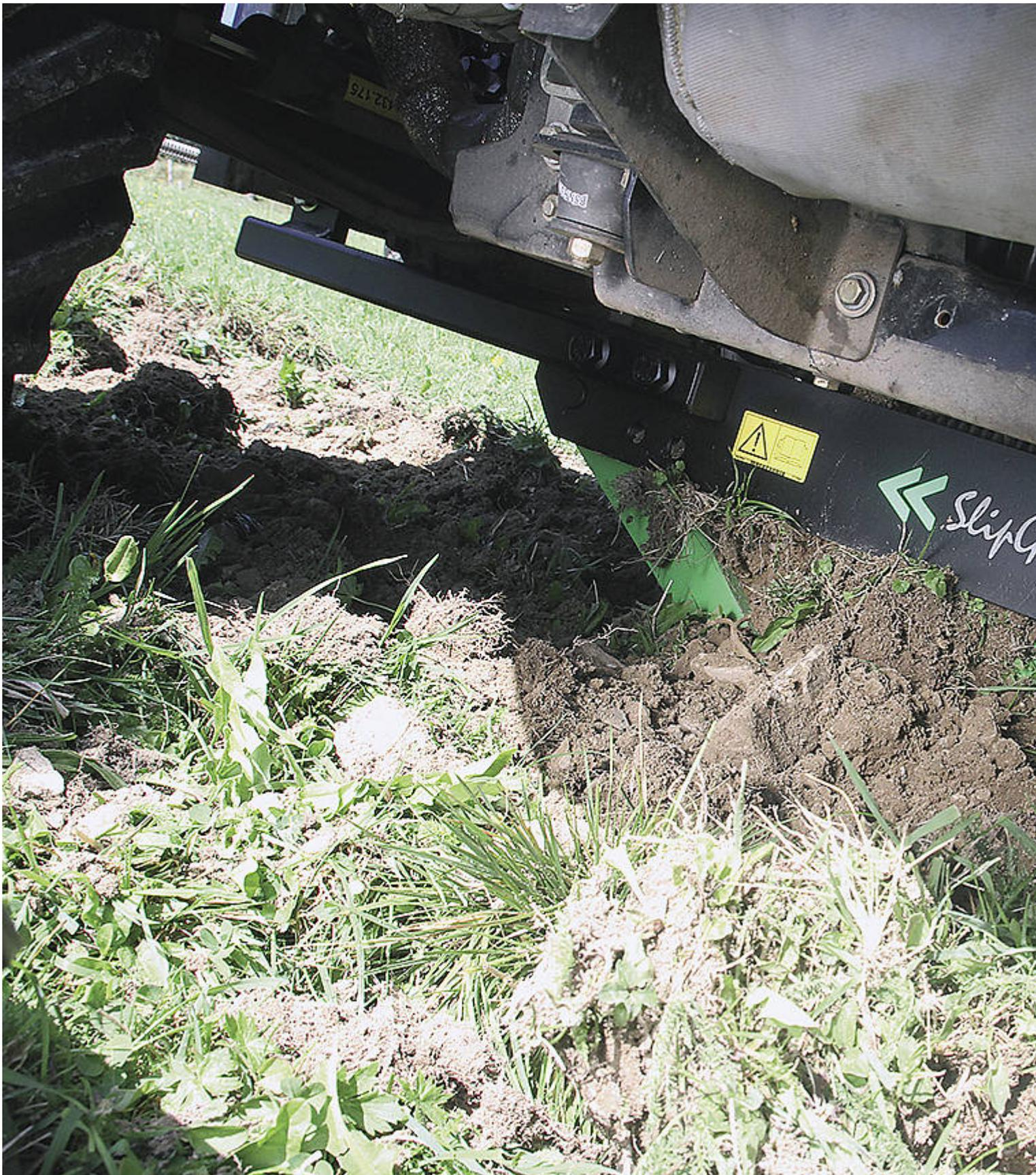
Je nach Fahrtrichtung bohrt sich eine der beiden massiven Bremsklappen wie ein Rettungsanker in den Boden und stoppt das F
