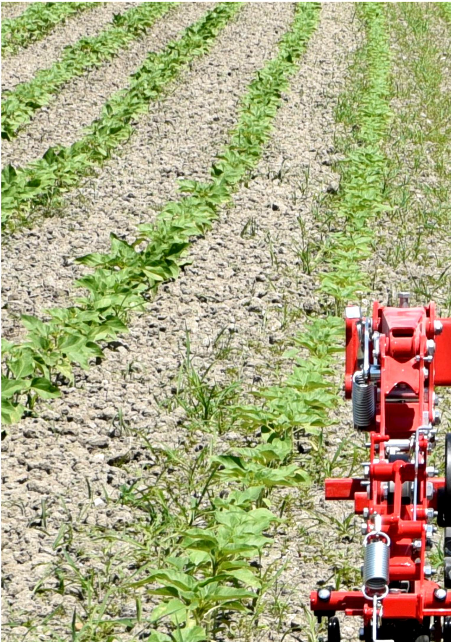
Neu am Chopstar-Prime ist die Schnellverstellung der einzelnen Zinkenträger sowie der Schutzelemente.
