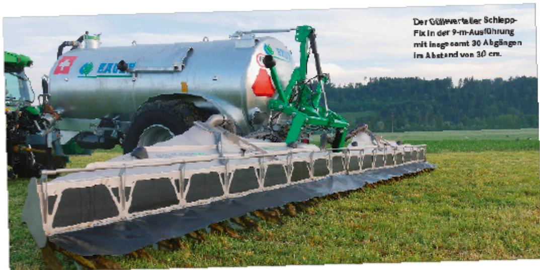
Der Gülleverteiler Schlepp-Fix in der 9-m-Ausführung mit Inage samt 30 Abgängen im Abstand von 30 cm.
