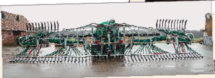
Vogelsang-Schleppschubgestänge SwingMax Slide, Arbeitsbreite 21 Meter.
