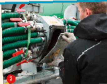
Wartungsklappe öffnen, Deckel abnehmen.
