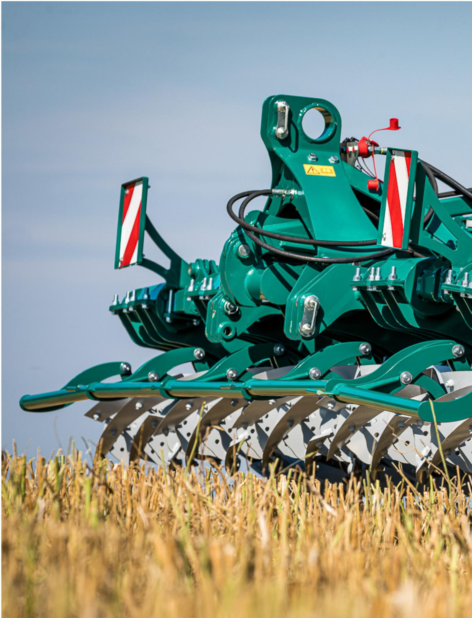
Die neue Messerwalze von Eidam bietet eine Arbeitsbreite von drei bis fünf Meter im Heck- und/oder Frontanbau.
