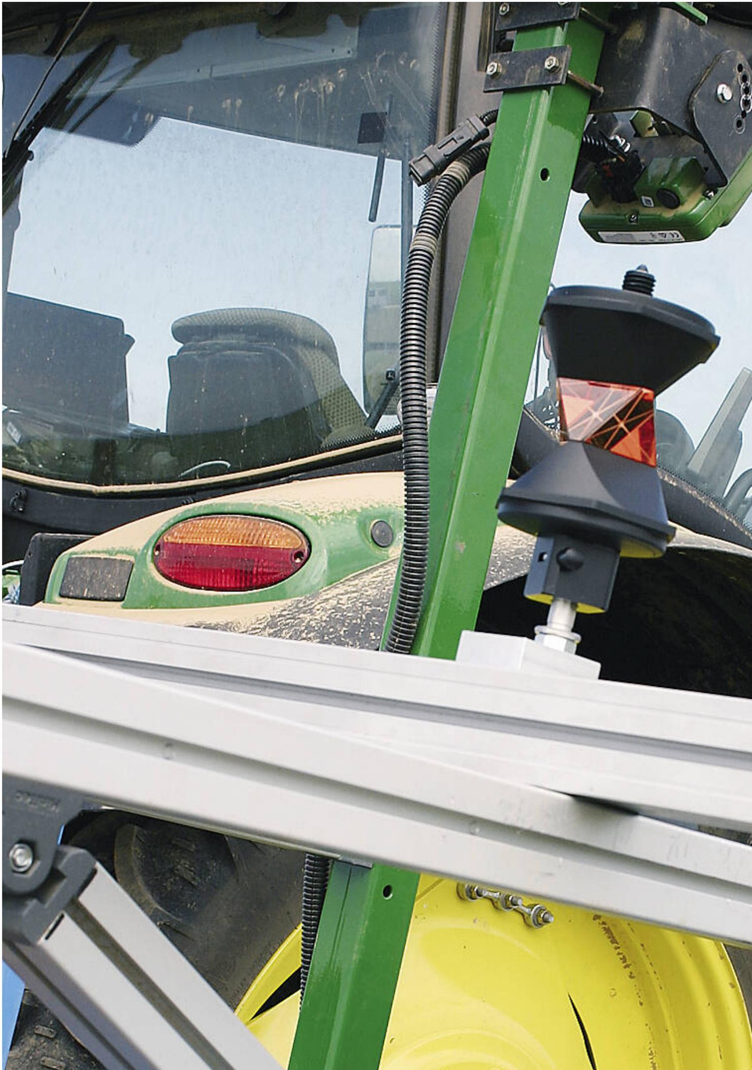
Am Hackgerät montiertes Prisma.
