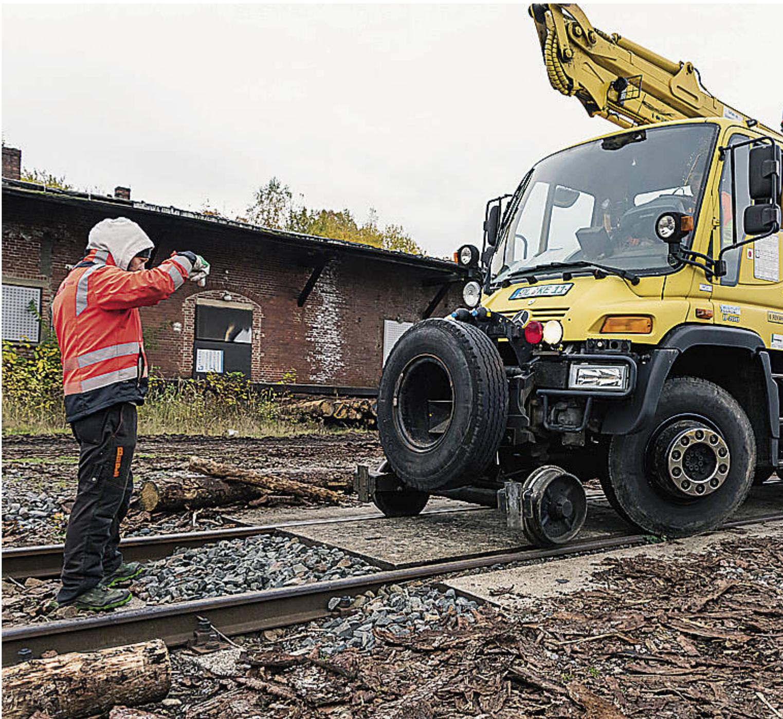
Auf ein Zeichen von Mitarbeiter Mario Glöcker löst der Fahrer des Spezial-Unimog das Absenken des Eisenbahnfahrgestells aus
