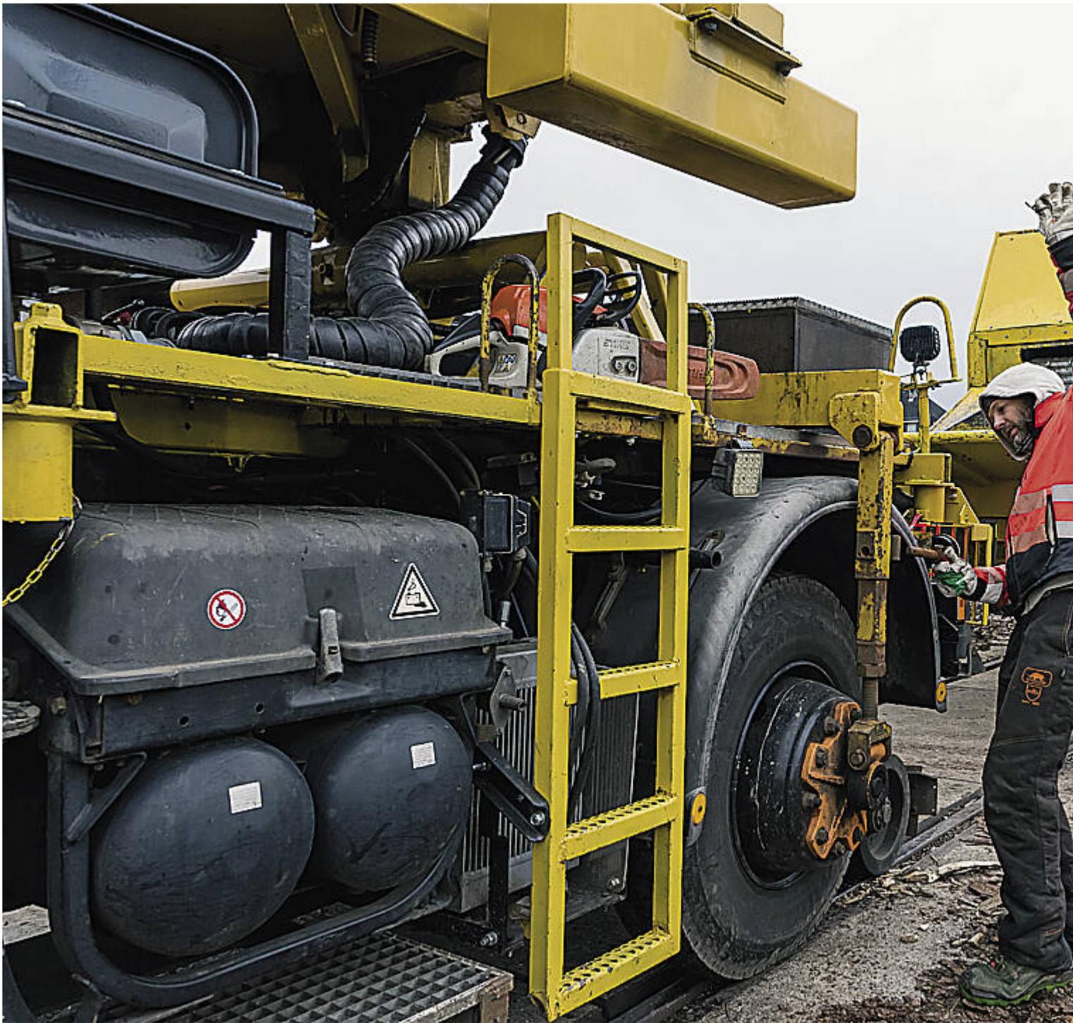
Eine auf die Achsen aufgesetzte und mit Bolzens fixierte Vorrichtung begrenzt den Federweg des Fahrzeugs und verhindert so e
