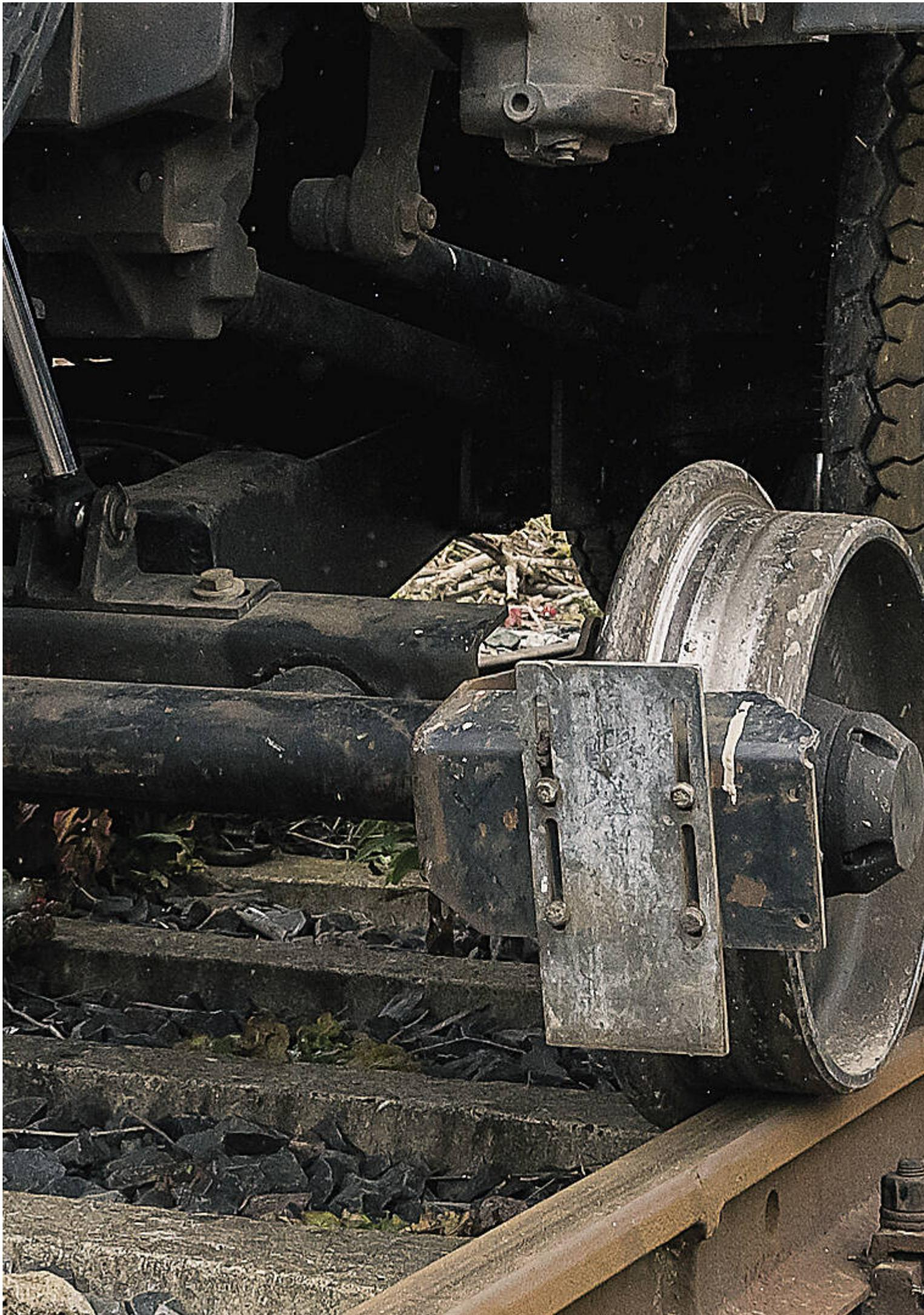
Bei der Schienenfahrt liegt die Hälfte der Fahrzeuglast auf dem Eisenbahnfahrgestell. Die andere Hälfte verbleibt auf den Rädern.
