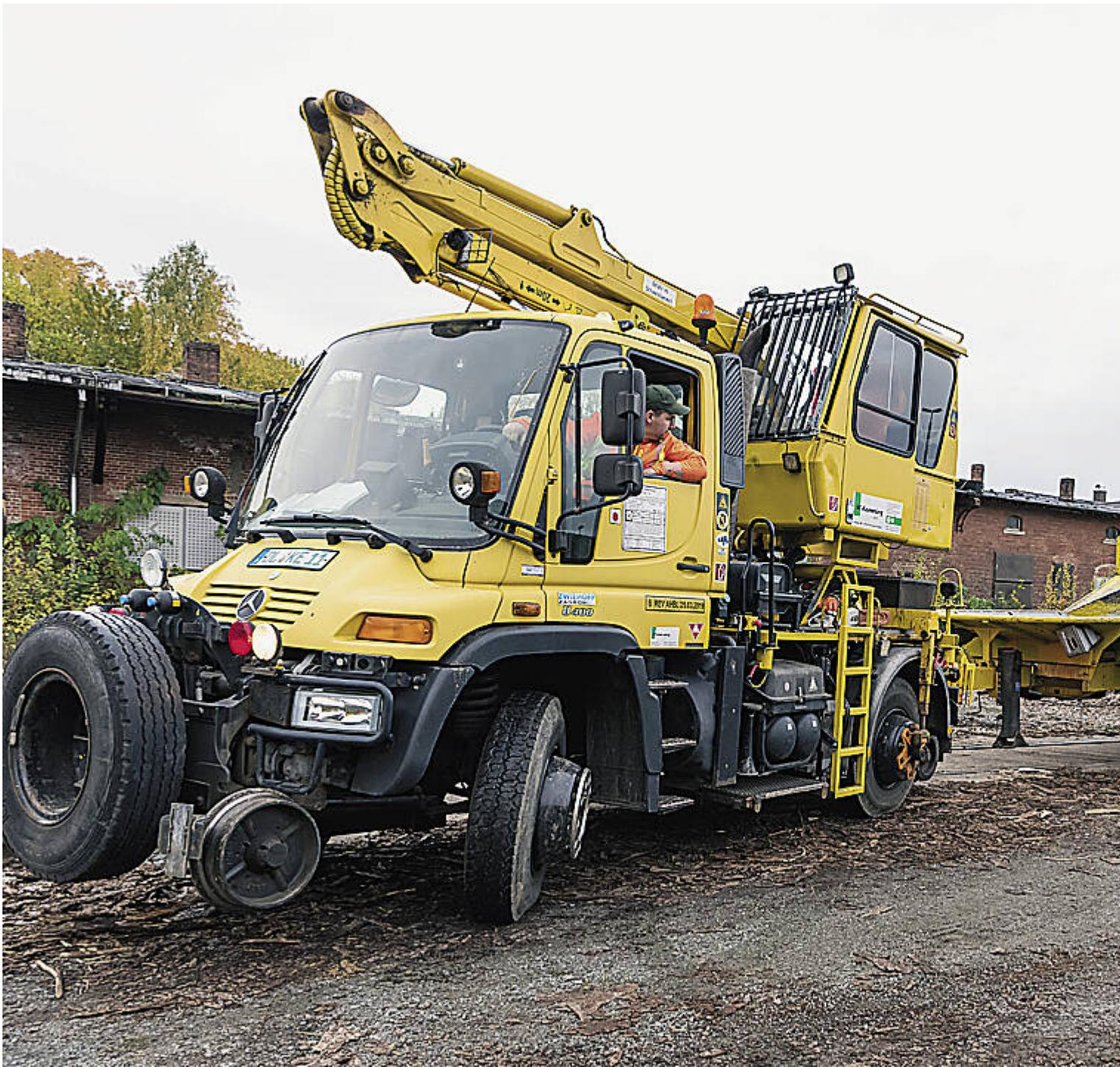
Beim Eingleisen lenkt Fahrer Nick Heidemann zunächst den angehängten Großhäcksler auf die Schienen im Rangierbereich des
