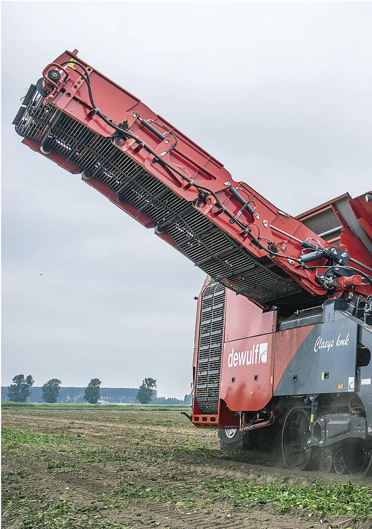
Der Kwatro G II besitzt einen zweiteiligen Bunker mit Sieb-ablade-Elevator.
