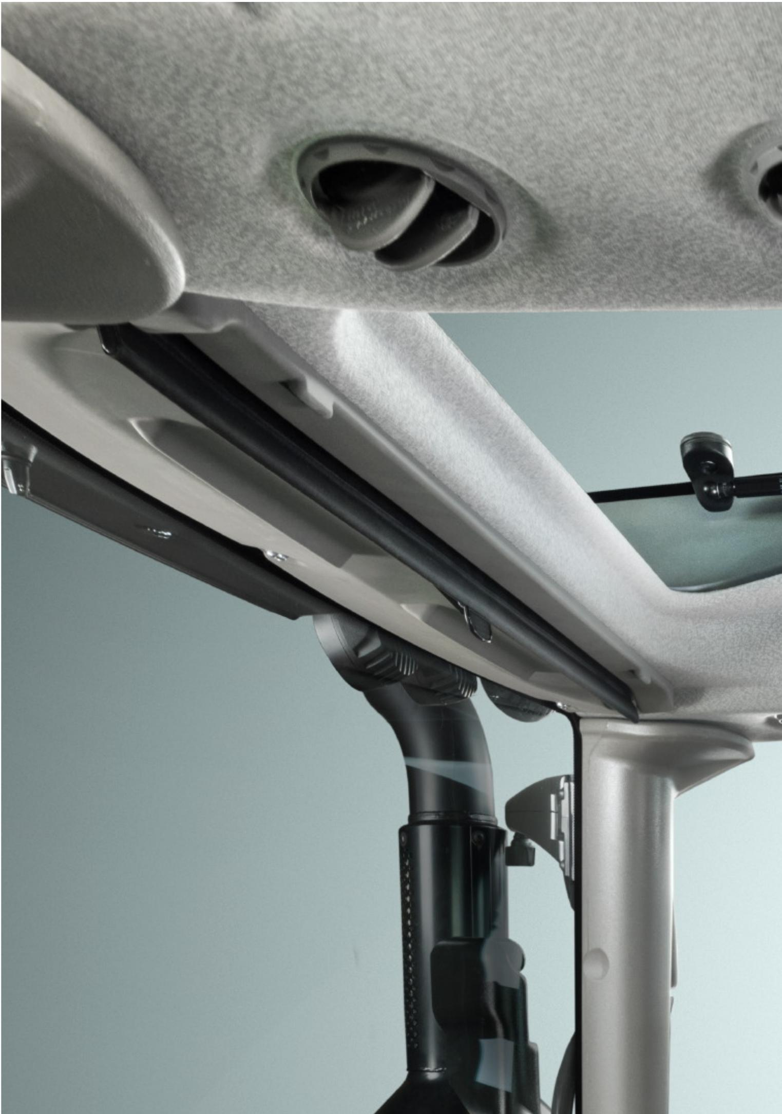
Zum Zubehör der neuen Top-Vision Kabine gehören die komplett einstellbare Lenksäule, der pneumatisch gefederter Fahrersitz, der klappbarer Beifahrersitz sowie das aufstellbare Freisichtdach.
