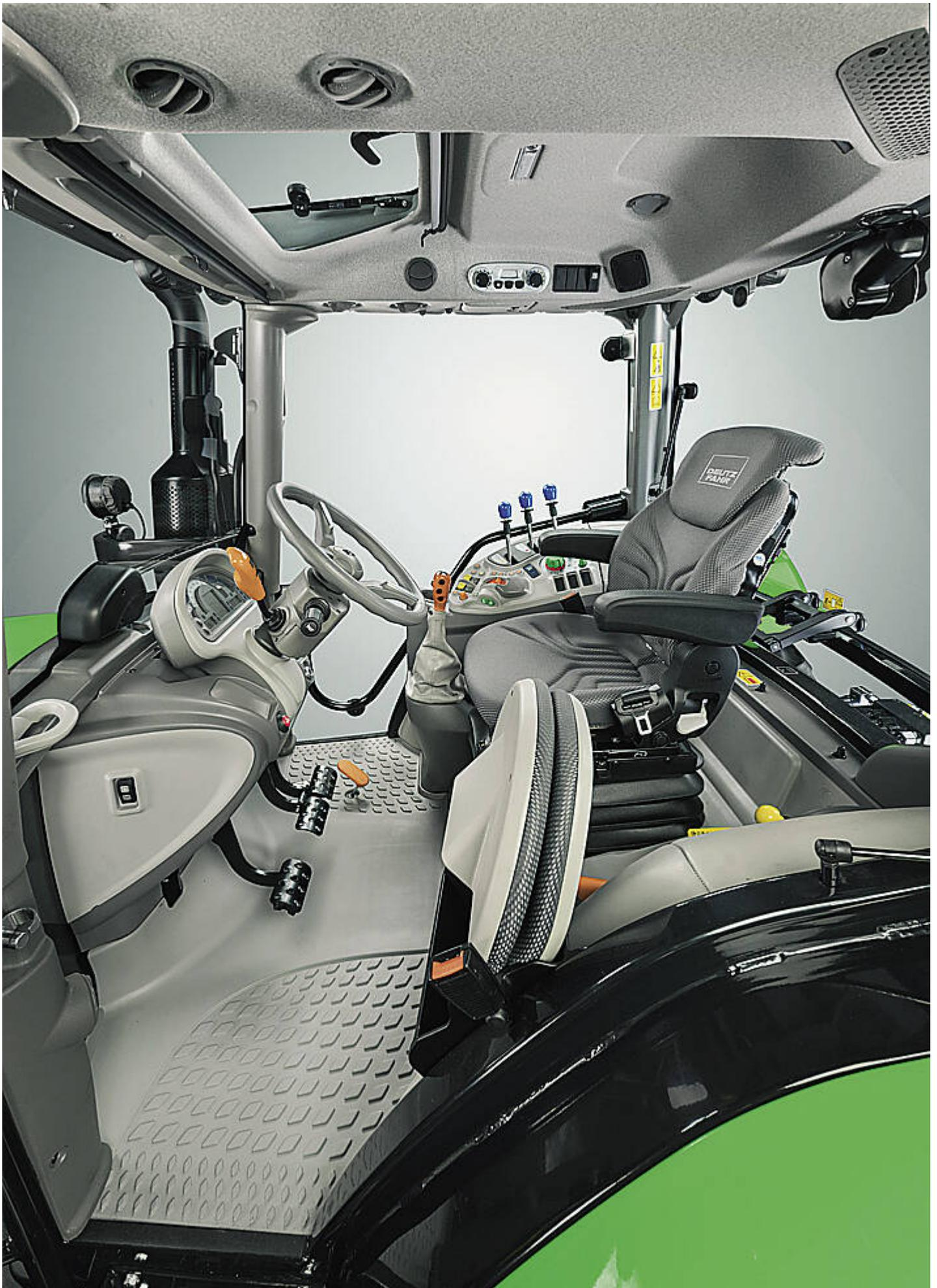
Zum Zubehör der neuen Top-Vision Kabine gehören die komplett einstellbare Lenksäule, der pneumatisch gefederte Fahrersitz, der klappbare Beifahrersitz sowie das aufstellbare Freisichtdach.
