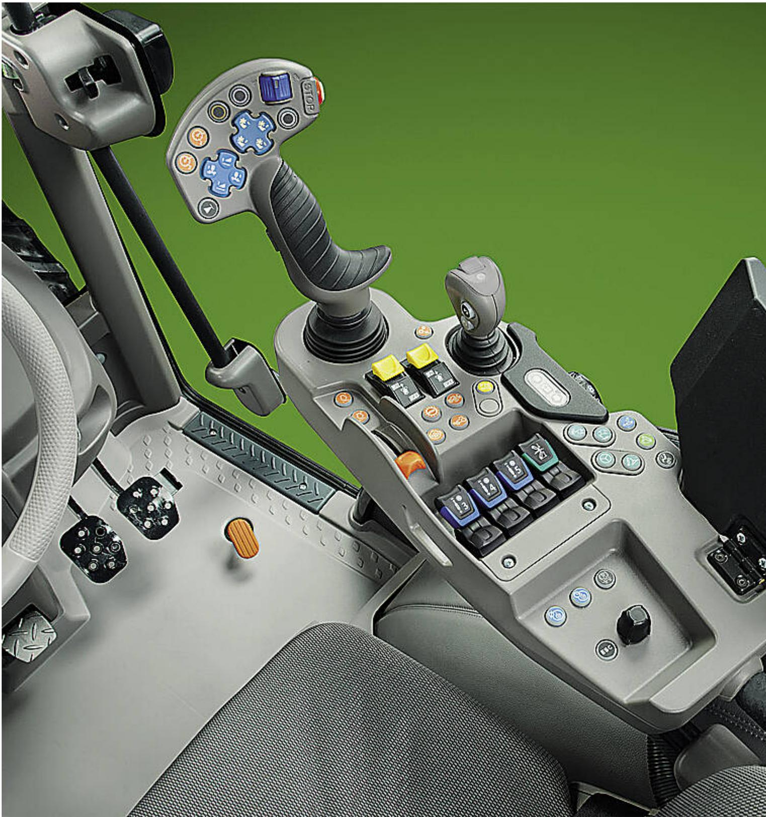
Mit der MaxCom Bedienarmlehne lassen sich alle Funktionen per Joystick steuern.
