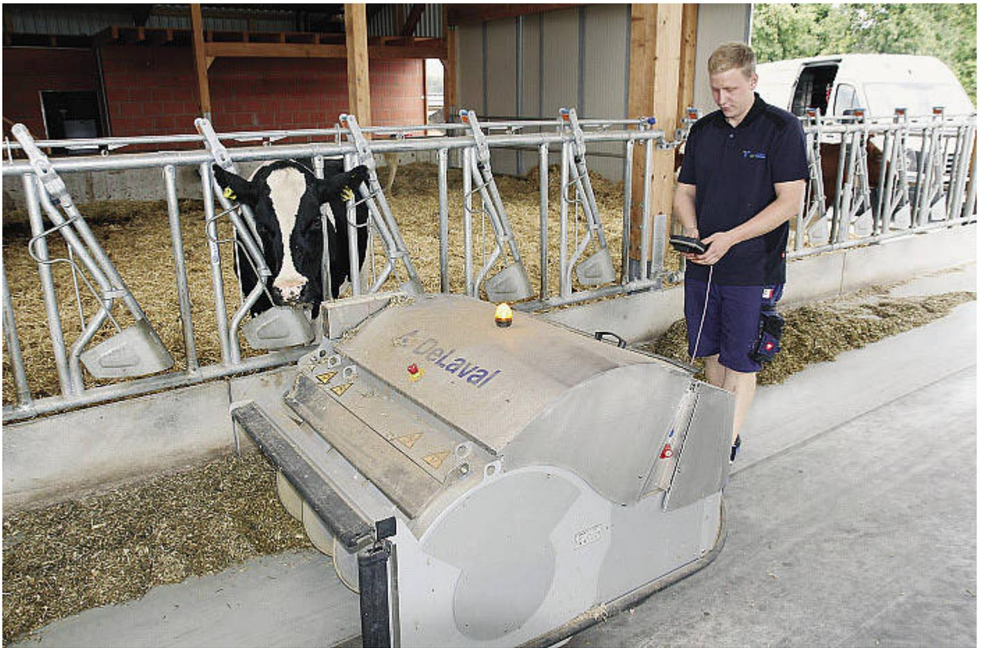
Zu den Aufgaben der Agrardienste von DeLaval gehört auch die Wartung von Spaltenschiebe- oder (wie im Bild) Futteranschieberobotern.
