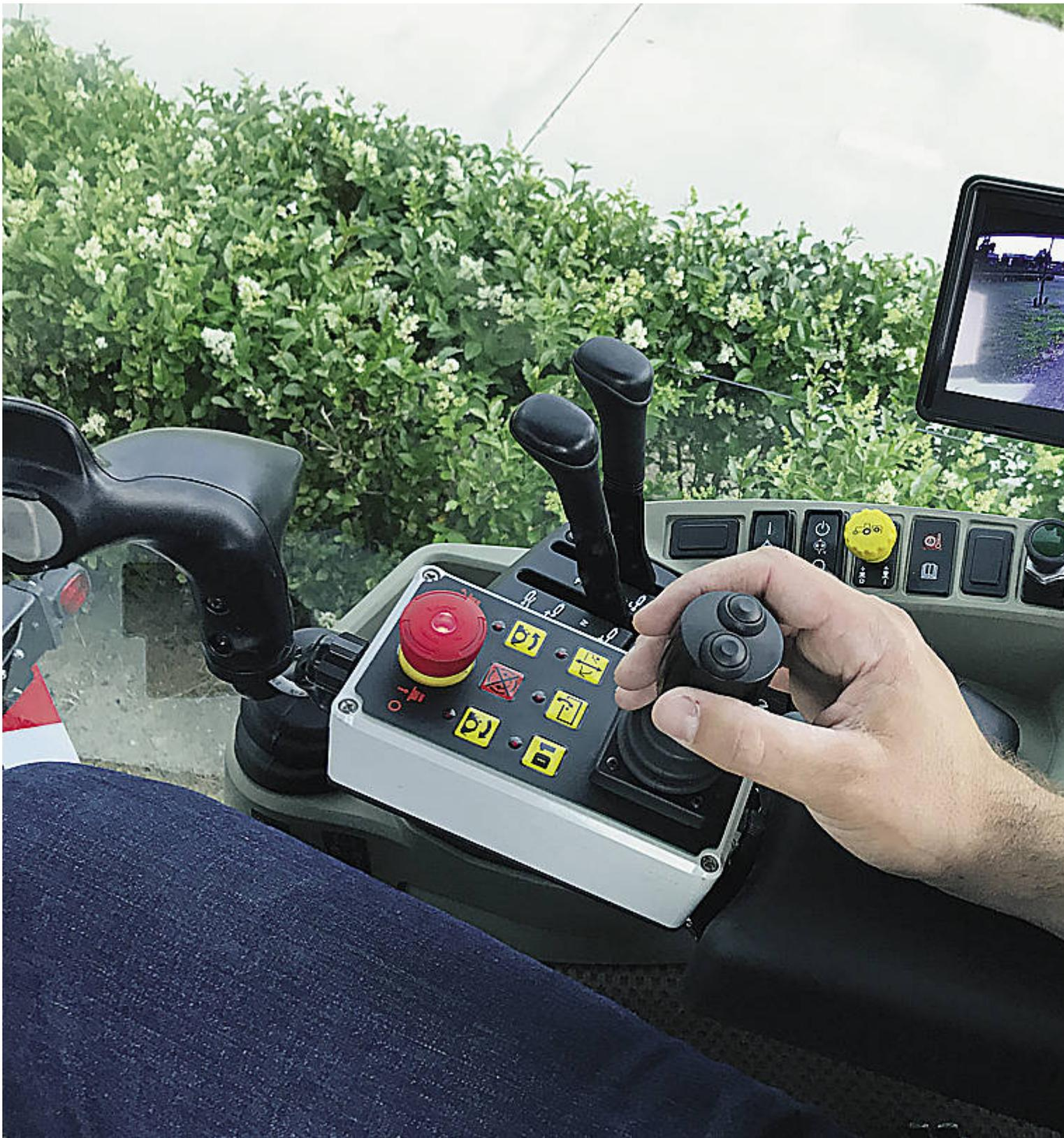
Die Elektro-Proportionalsteuerung ermöglicht das Heben, Senken und die Kopfwinkelverstellung.
