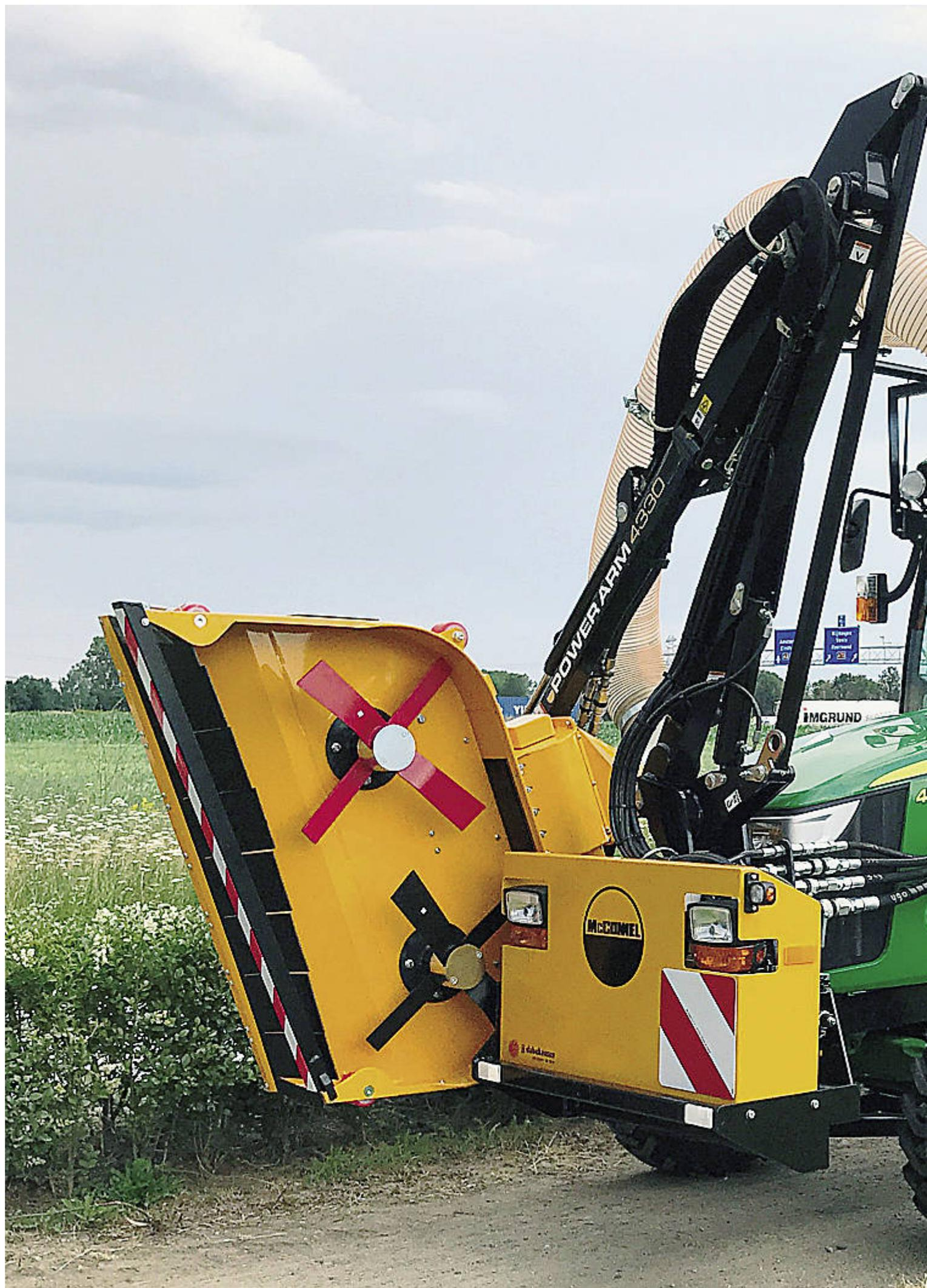
Die Häckseleinheit wird beim Heckenprofi Gen II von Dabekausen direkt auf das Mähwerk Power RM1250Pro montiert.
