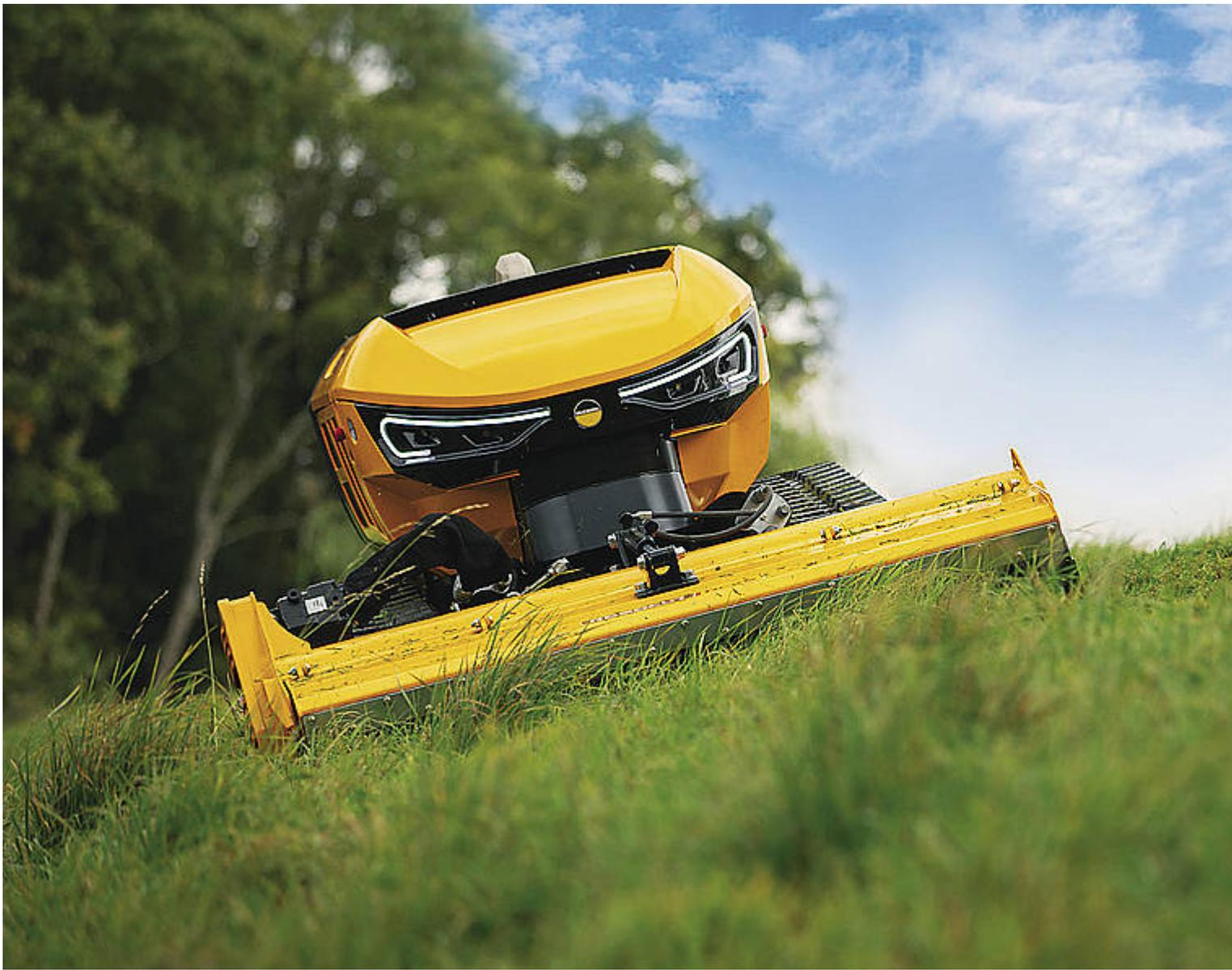
Robocut RC 28 mit Elektro-Hybridantrieb.
