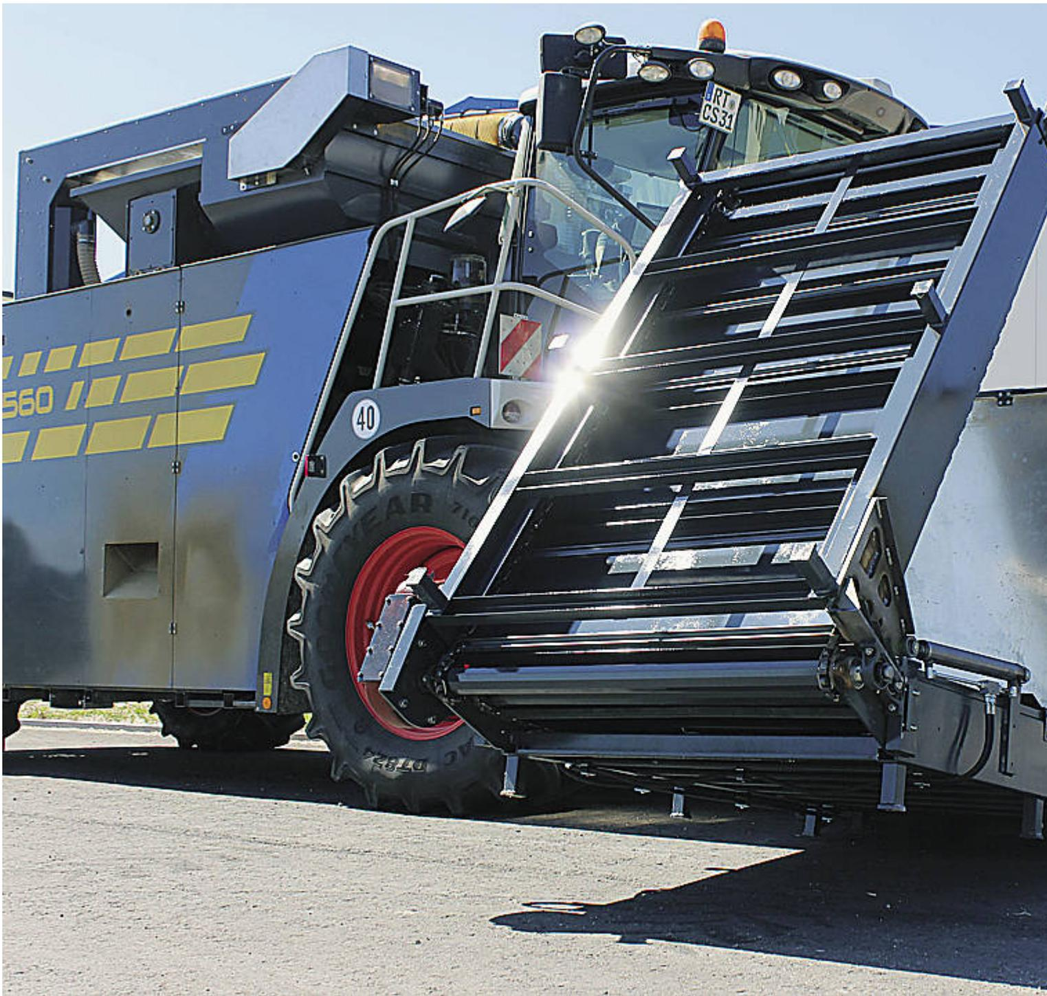
Ist das Modul ausgeklappt und bereit, wird lediglich eine weitere Person benötigt, die den Auflöser bestückt – beispielsweise mit dem Ballen muss nur noch das Pressgarn entfernt werden.
