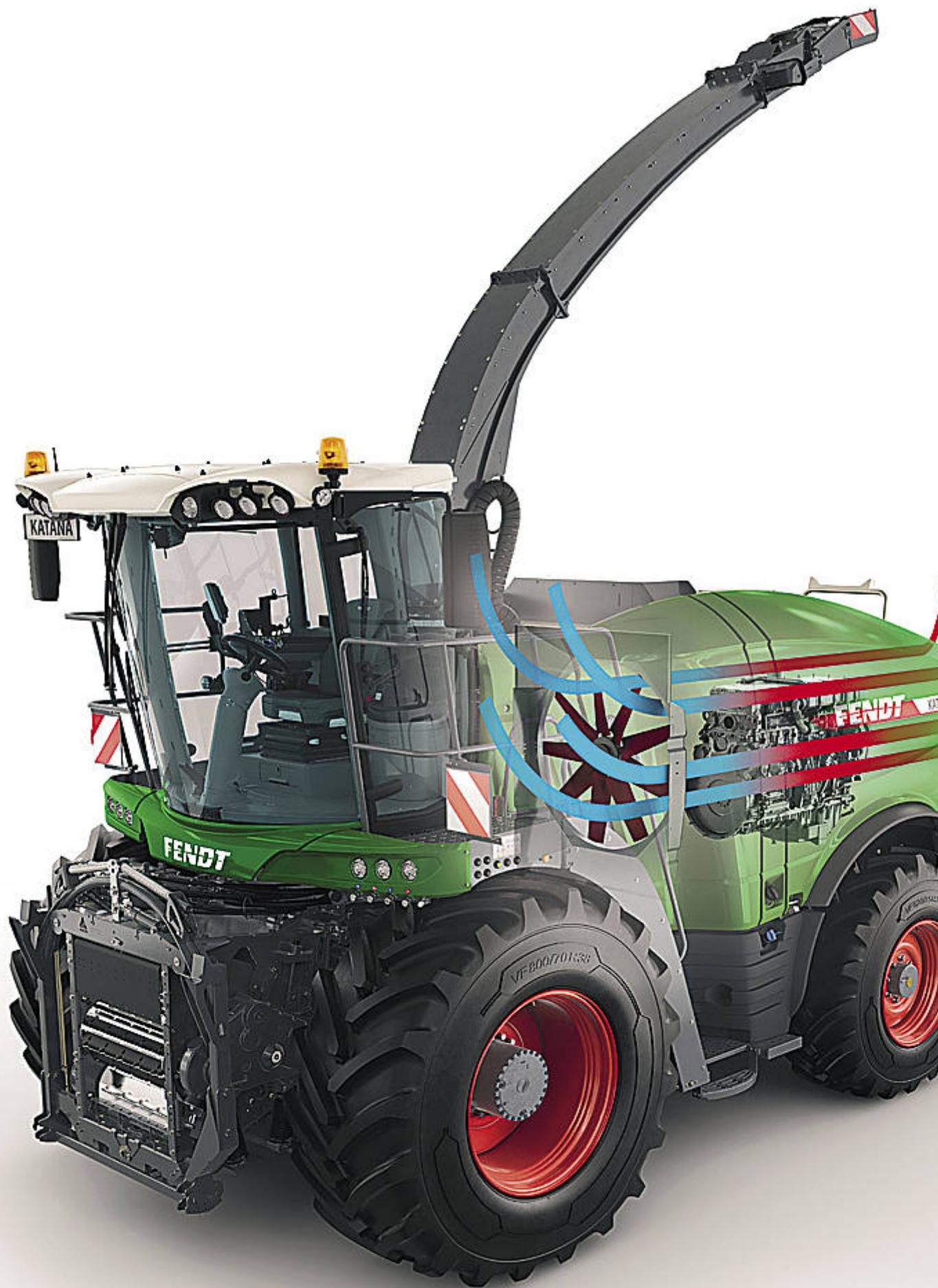
Der Fendt Katana mit Cleanfix-Umschaltventilator.
