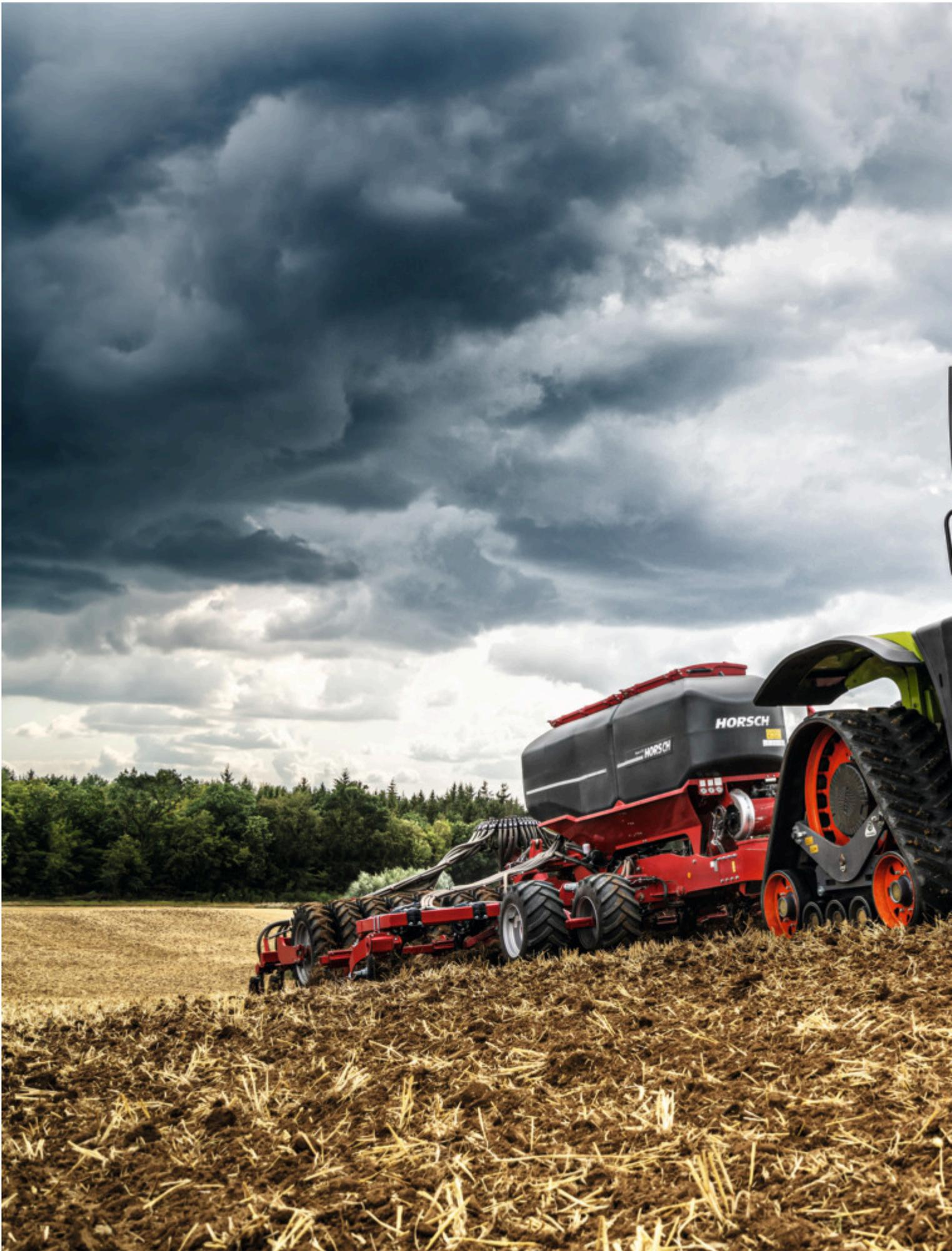
Das Raupenfahrwerk soll für sichere Zugkraftübertragung und niedrigen Bodendruck sorgen.
