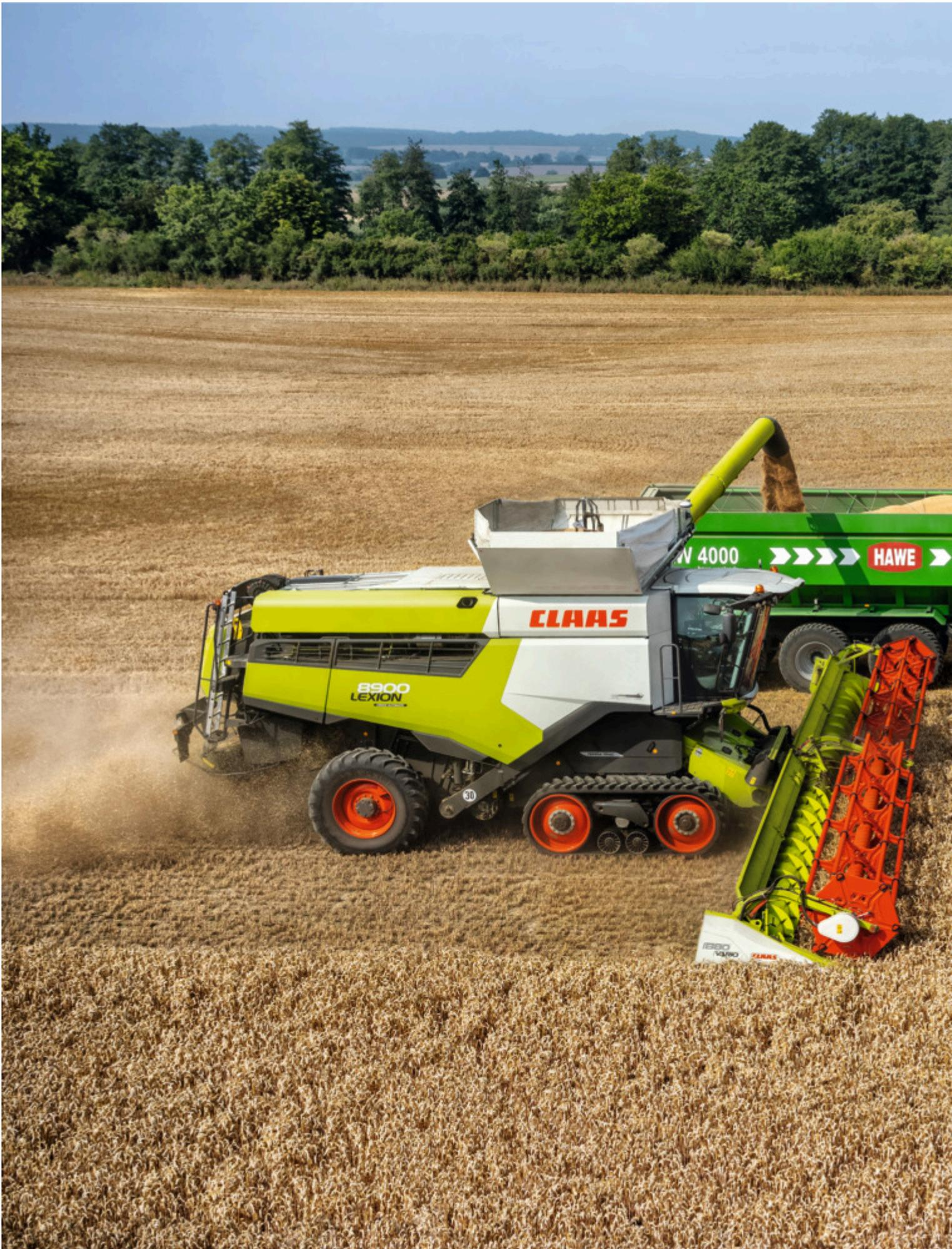
Die beim Mähdrescher und Feldhäcksler eingesetzten Terra Trac-Raupenlaufwerke schonen mit ihren großen Aufstandsflächen den Boden und sorgen für mehr Komfort. Claas bietet sie jetzt auch für den Traktor Axion an.
