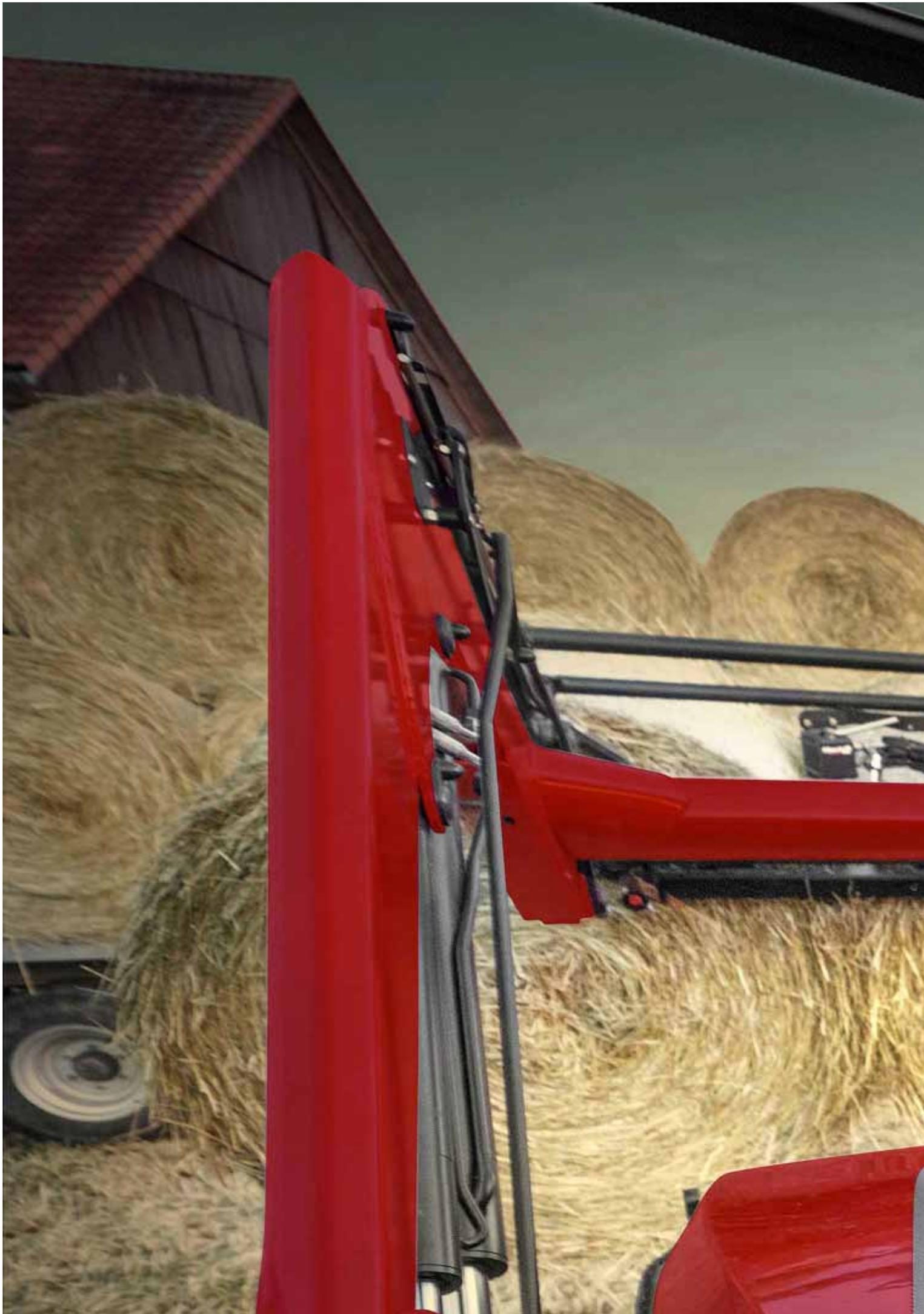
Gesteuert werden der Lader und die 3. und 4. hydraulische Funktion über die Steuergeräte und Joysticks des Traktors.
