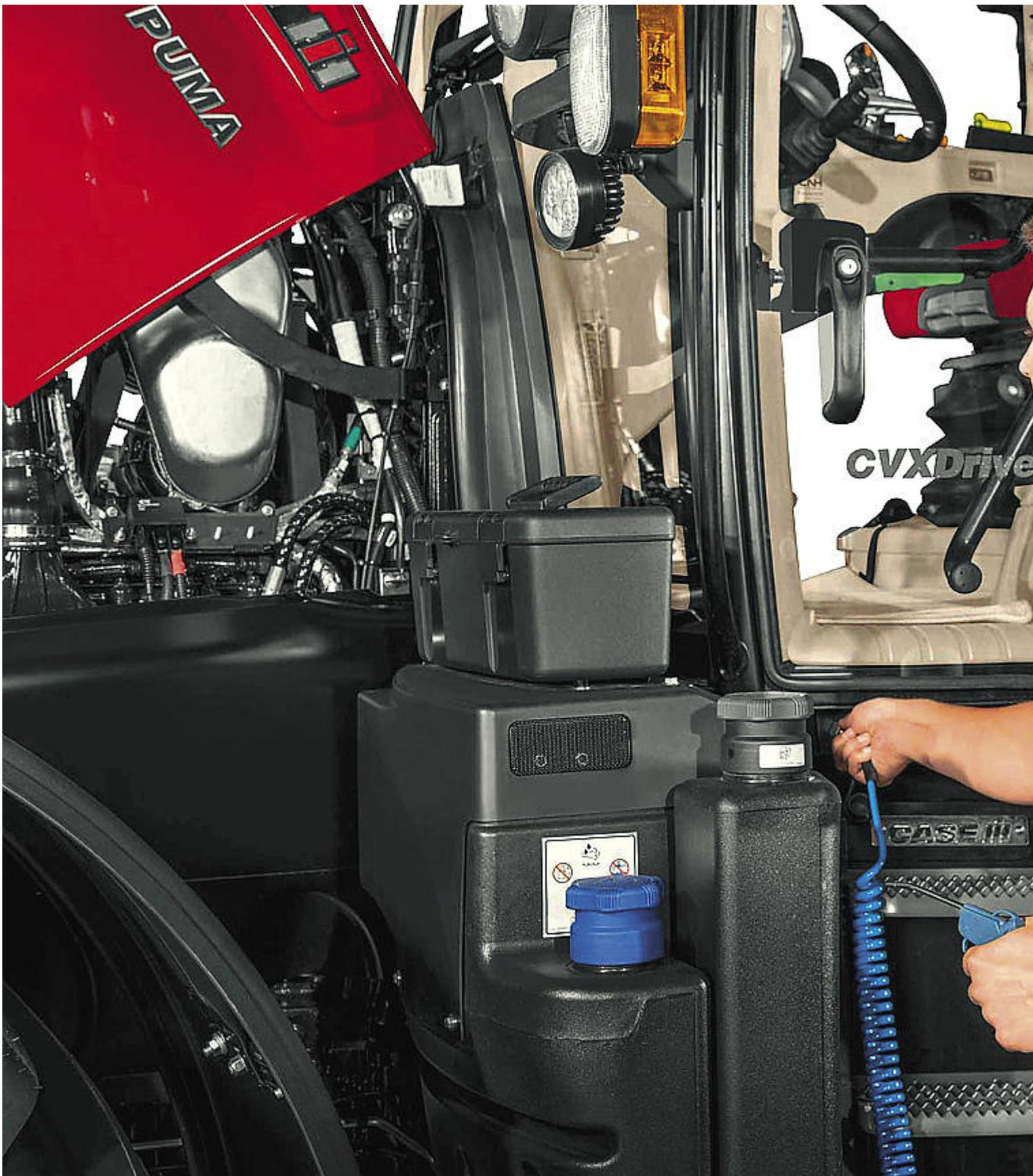
Optimal positioniert: der neuartige Druckluftanschluss.
