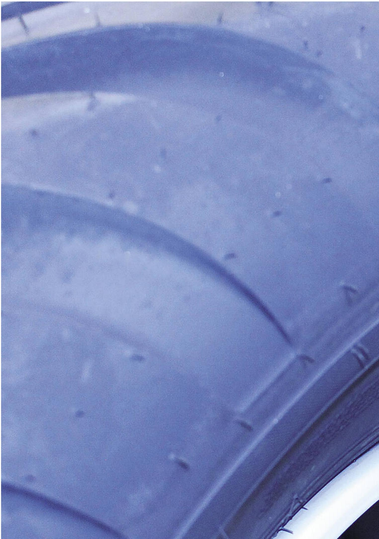
3. Hält der Reifen den Luftdruck, liegt aber mit der Wulst noch nicht ringsherum am Felgenhorn an, darf der Druck maximal auf Springdruck erhöht werden, damit der Reifen aus dem Tiefbett über den Felgenhump in die Endposition springt.
