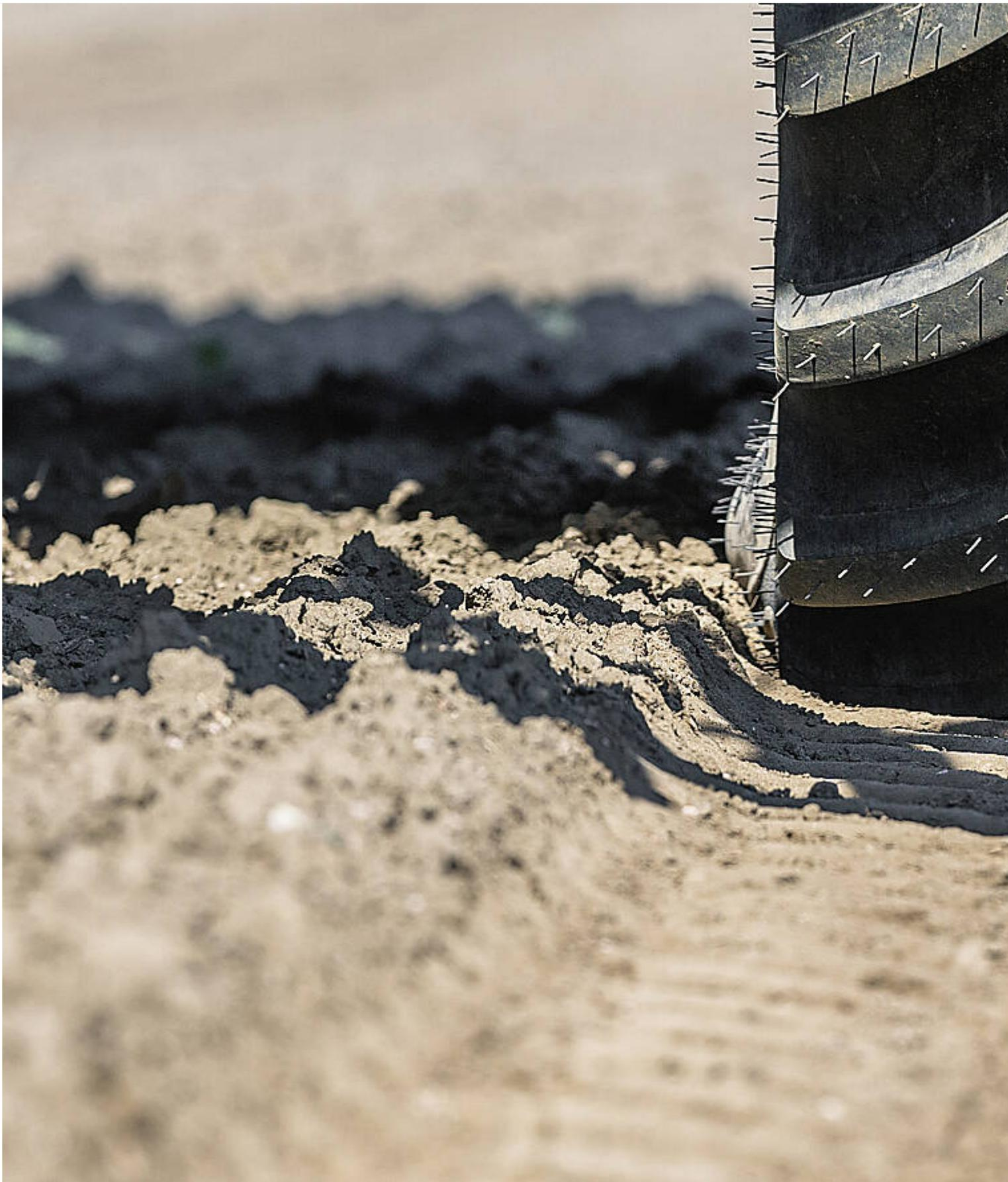
Die Aufstandsfläche der IF- oder VF-Reifen ist nicht nur breiter, sondern auch länger als bei der Standardbereifung.
