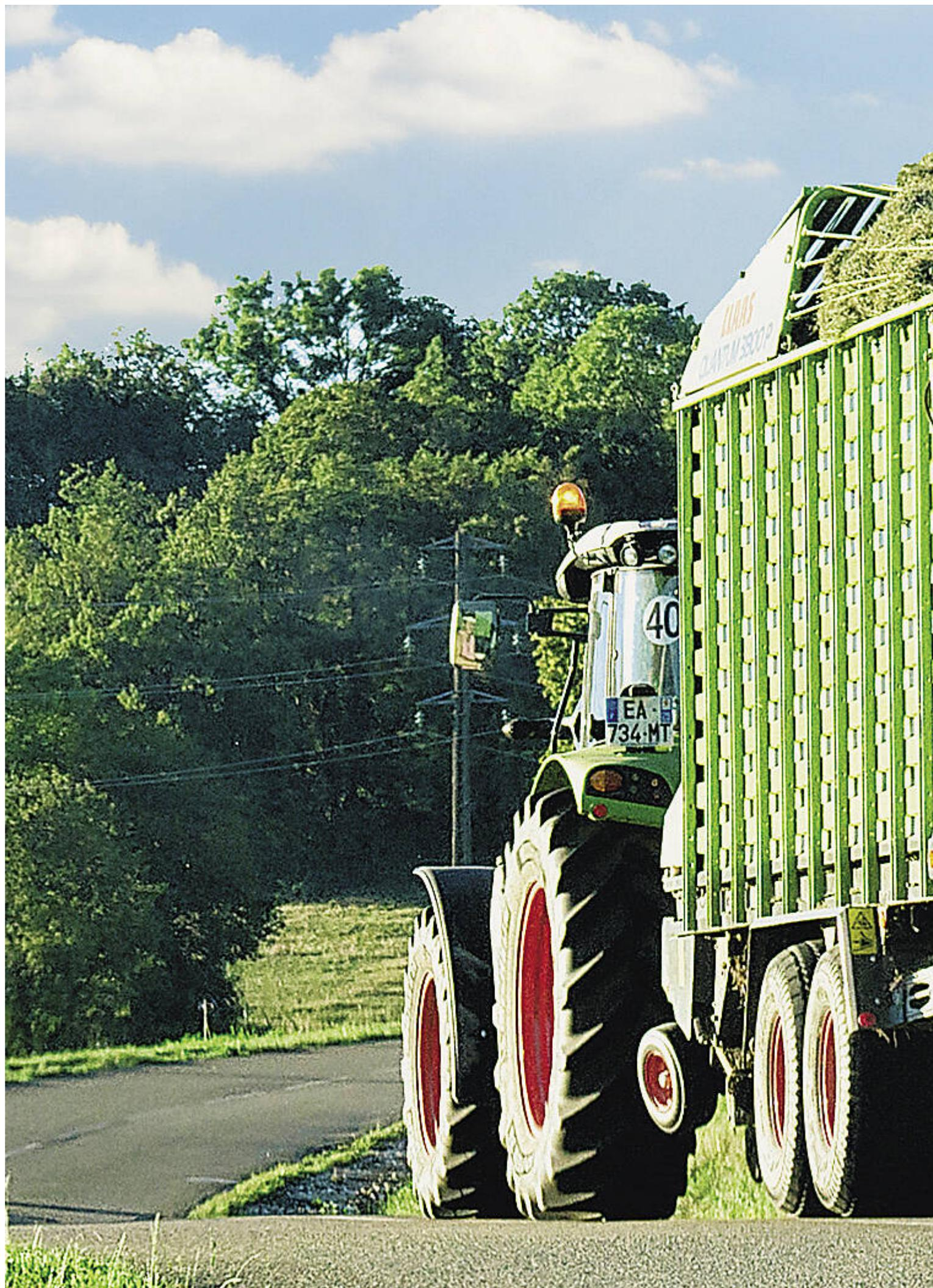
IF-/VF-Reifen ermöglichen eine Erhöhung der Tragfähigkeit um 20 % bzw. 40 %.
