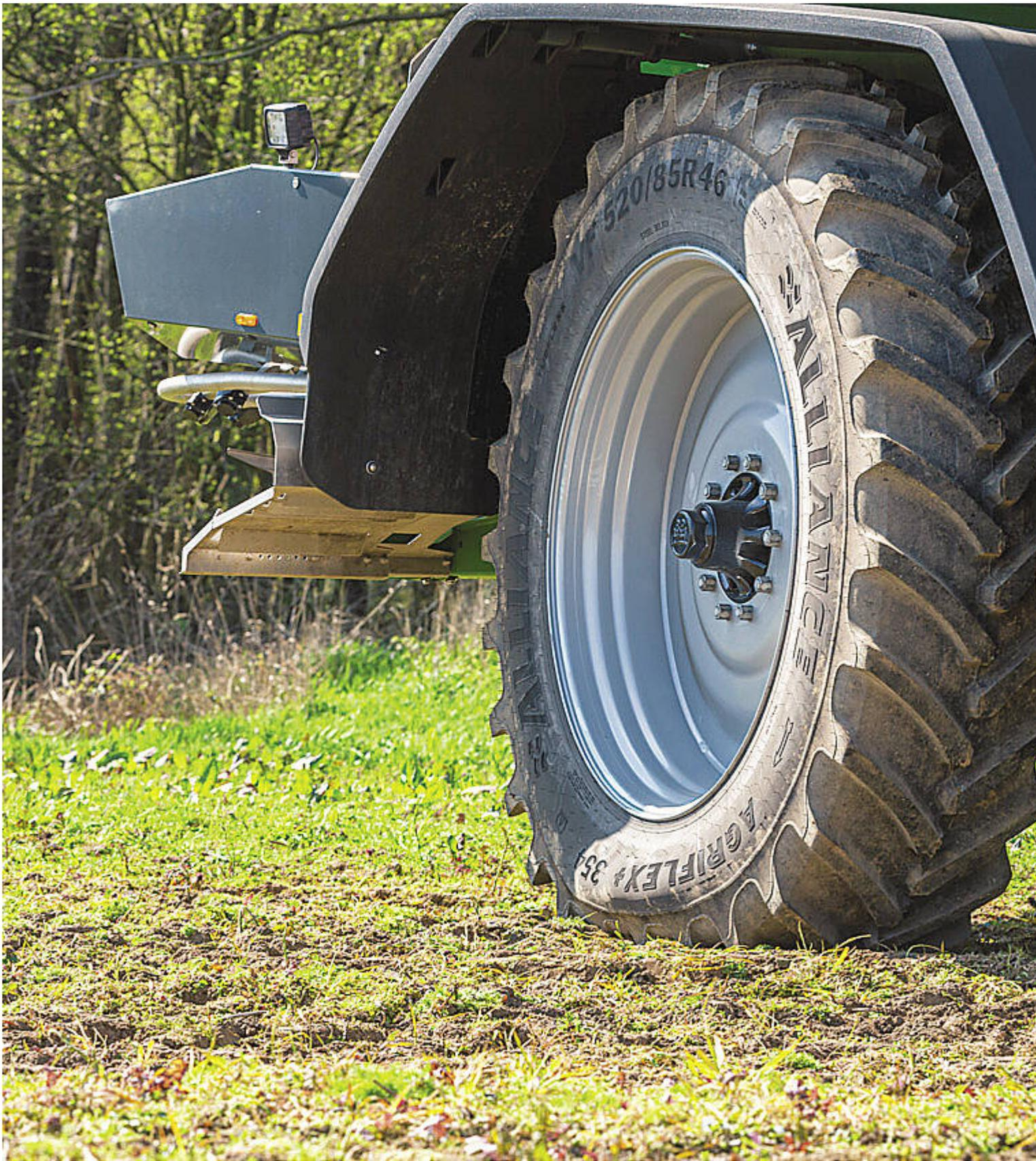
Längere Aufstandsfläche durch IF-/VF-Technologie – auch für Pflegebereifung.
