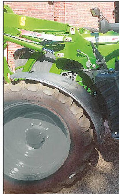
Traktoren sind individuell ausgestattet, deswegen müssen Abstände wie die zum Druckluftkessel und zu Kotflügeln bei der Ausw
