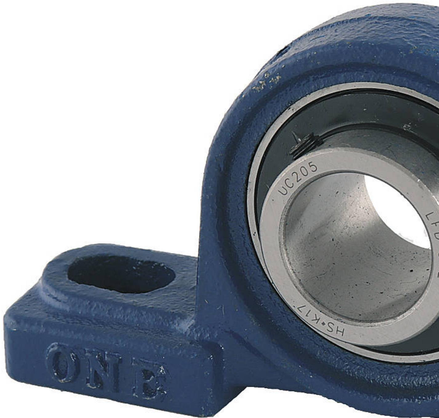
Stehlager mit gedichtetem Rillenkugellager. Der Festsitz der Welle wird mittels Madenschrauben gewährleistet.
