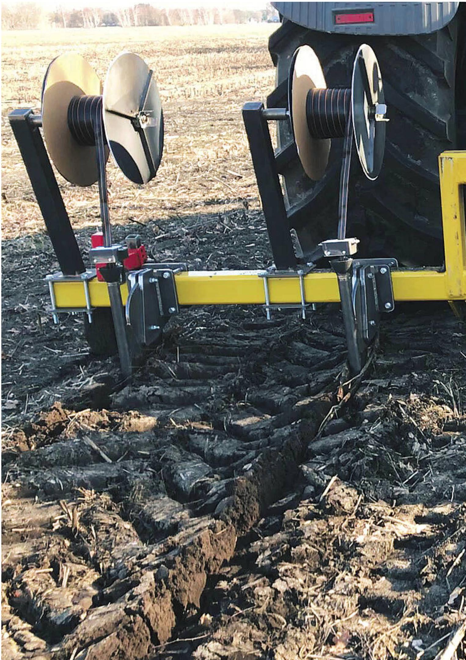
Das tiefere Einbringen der Rohre für die Tropfbewässerung, etwa bei mehrjährigen Kulturen, erfolgt mit dem Verlegepflug, hier in der fünfreihigen Ausführung.
