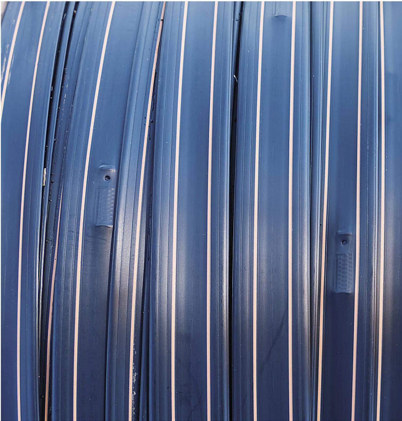
In dem aufgewickelten Netafim Tropfrohr sind die eingeschweißten Tropfelemente zu erkennen. Beim Typ DripNet PC sind sie in
