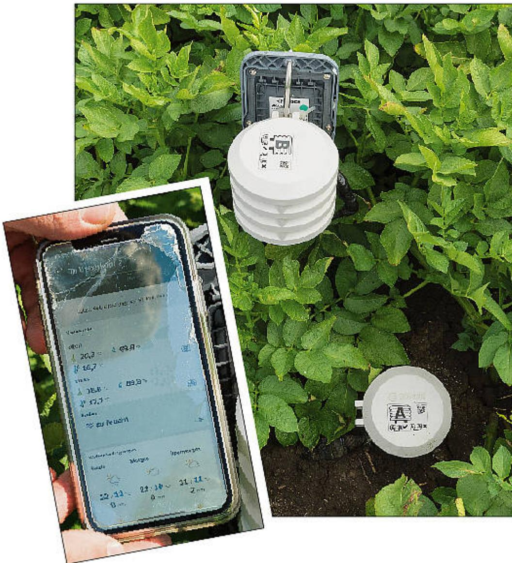
Messfühler für Temperatur und Luftfeuchtigkeit bei der Feldüberwachung Deepfield Connect von Bosch. Ein weiterer Sensor misst die Bodenfeuchtigkeit unter der Mutterknolle.
